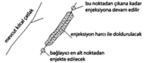
Şekil 36 Kılcal Çatlaklar İçin Onarım Detayı
