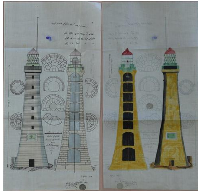
Resim 24. Elektrik fenerinin irtifa-ı 123 kalem Elektrik ışığının kuvveti 14.000 mum Elektrik ışığının menzili 14 mil (1893) 122
