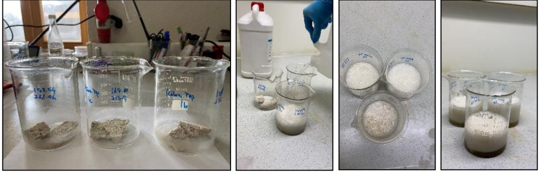
Şekil 2.1: Tartımı Alınan Örneklere HCl İlave Edilmesi
