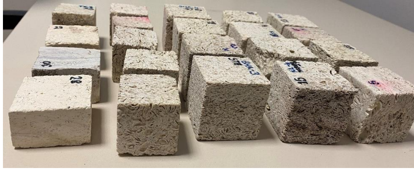
Şekil 2.43: Tuz Kristallenmesi Deneyi Sonrasında Numuneler
