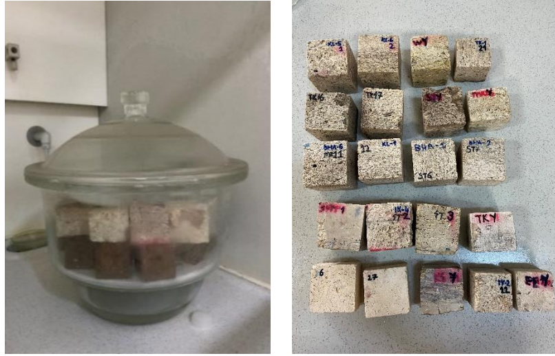
Şekil 2.55: SO 2 Yıpratma Deneyi Sırasında ve Sonrasındaki Numuneler
