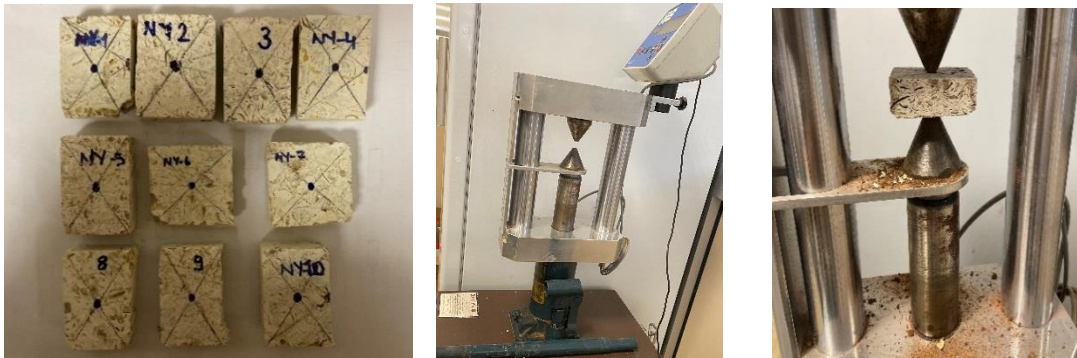
Şekil 2.16: Nokta Yük Deneyi Uygulanan Örnekler
