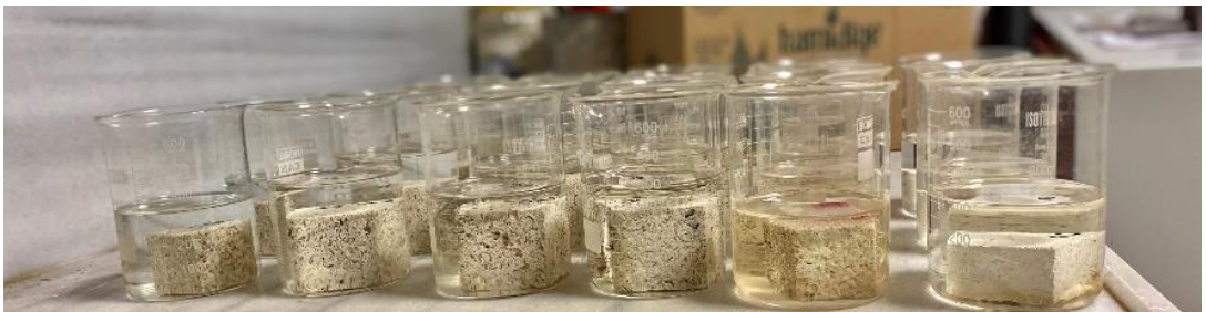
Şekil 2.42: Tuz Kristallenmesi Deneyi Sırasında Numuneler
