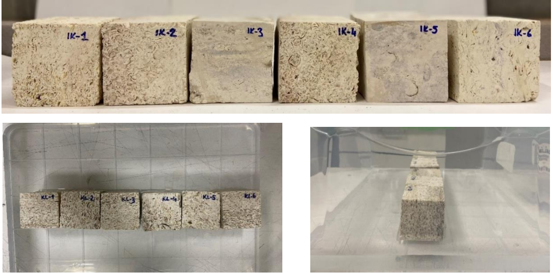
Şekil 2.14: Saf Su İçerisindeki Örneklerin Kılcallık Deneyi Sırasındaki Durumu
