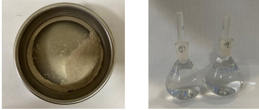
Şekil 2.11: Kurutulan Örneğin 90µ Elekten Geçirilmiş Durumu ve Piknometre
