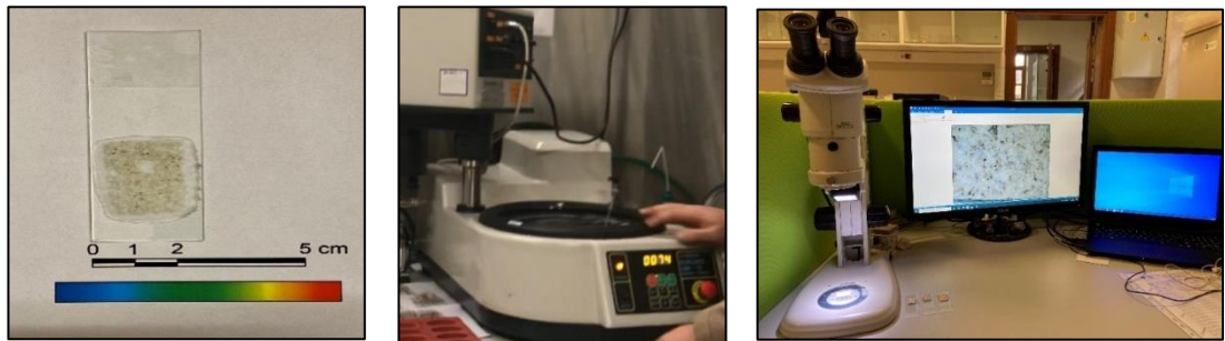
Şekil 2.3: Örneğin Zımparalanması ve İnce Kesit Hazırlanması
