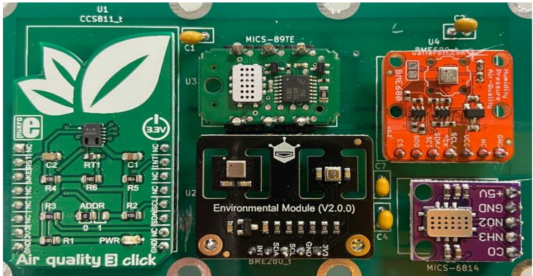
Şekil 3. 1: PCB Üzerine Yerleştirilen Sensör Modülleri
