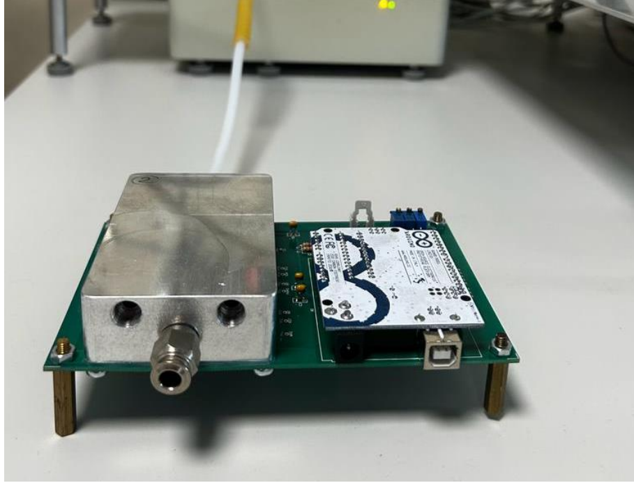
Şekil 2. 8: Sensör Ölçüm Hücresi ve Kartı (ELPAŞ Elektromekanik A.Ş.)
