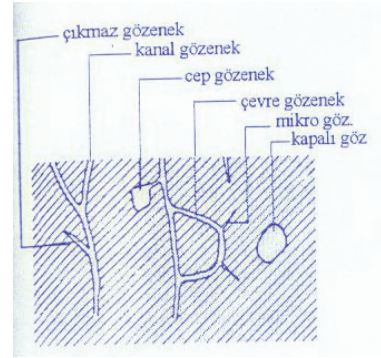
Şekil 3. Taşlardaki porozite türleri (Torraca, 1988).
