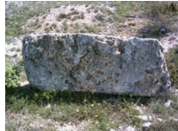
Şekil 7. Kırklareli Vize Antik Taş Ocağı yapı taşının atmosferik hava koşullarında uğradığı tahribat.
