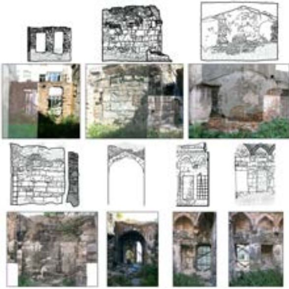
Çizim 6a. Restorasyon öncesi birinci kat duvar plan ve detayları
