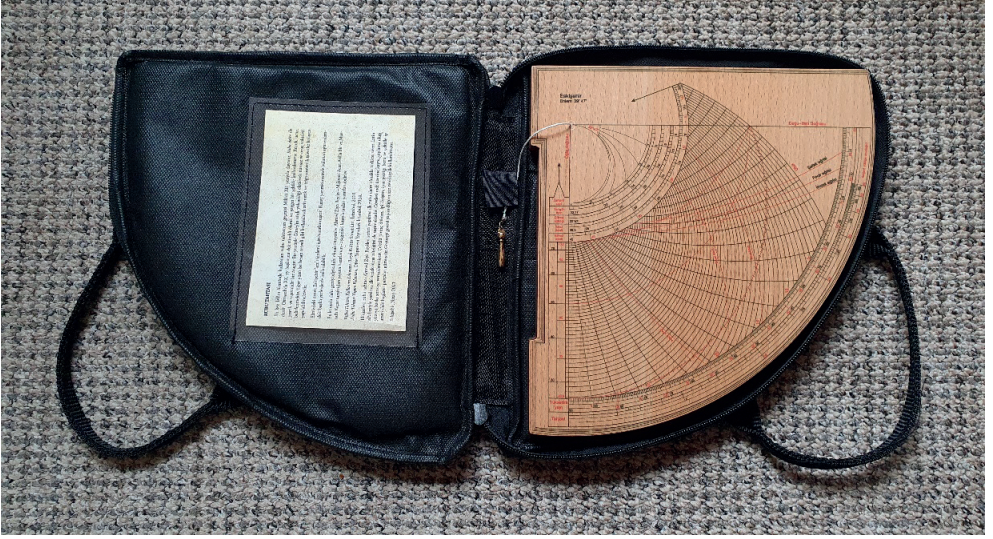
Rubu tahtası, özel çantasının içinde (üstte ve altta). Çantanın içinde çekül için minik kapaklı bir cep ile bilgi kartı için bir şeffaf cep vardır.
