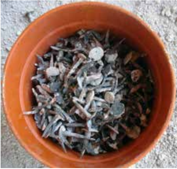
Fotoğraf 29. Özelliğini yitirmiş ve paslanmış demir çiviler
