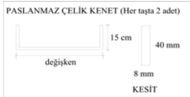
Şekil 5. Paslanmaz çelik kenet uygulama detayı
