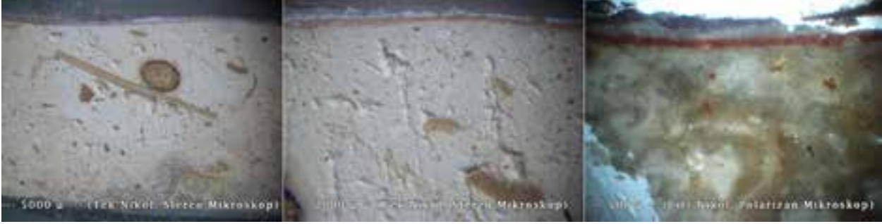
Fotoğraf 2. Örnek 6'nın genel dokusu ve yüzeyinde bulunan boya tabakası. Kireç bağlayıcı içeriğinde bulunan kalsit, kırıktık, siyah cüruf parçacıkları ile tek tük tuğla kırıkları ve kuvars parçacıkları
