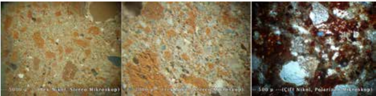
Fotoğraf 4. Örnek 13'ün genel dokusu. Kireç bağlayıcı içeriğinde bulunan tuğla-keramik kırıkları ve tozu ile kalsit, kuvars ve siyah cüruf parçacıkları.
