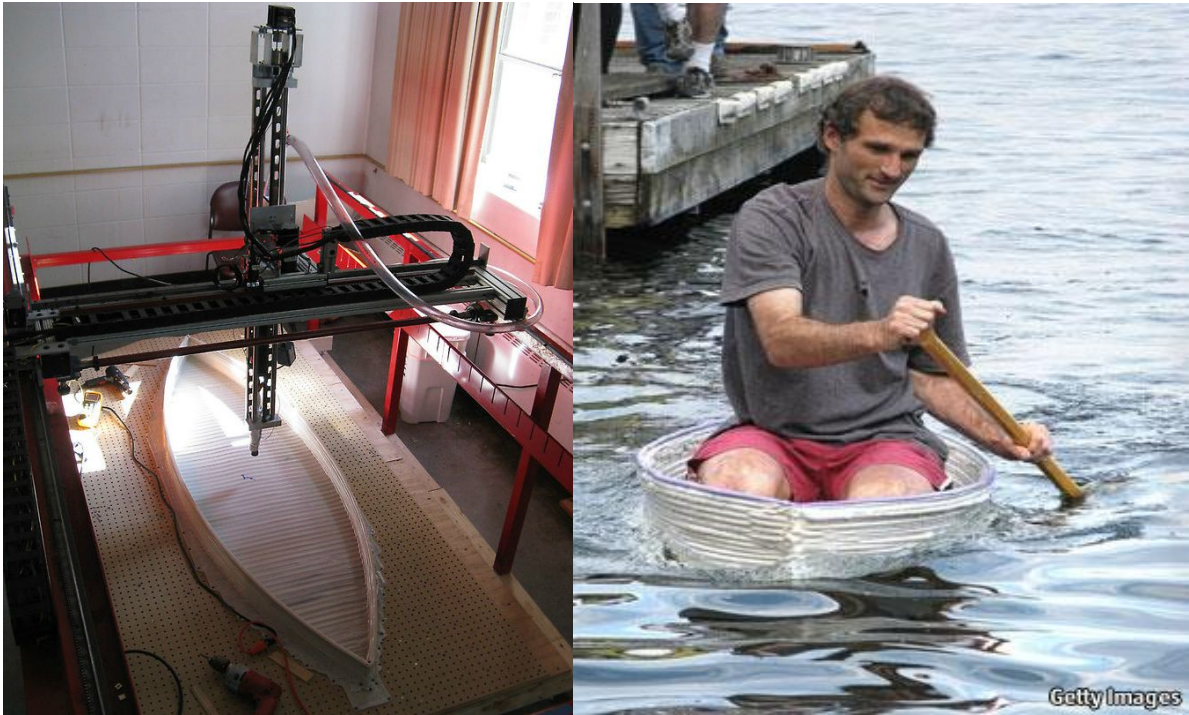
Şekil 5. Bay Rogge ve arkadaşlarının 3D Baskı ile ürettikleri tekne [3]
