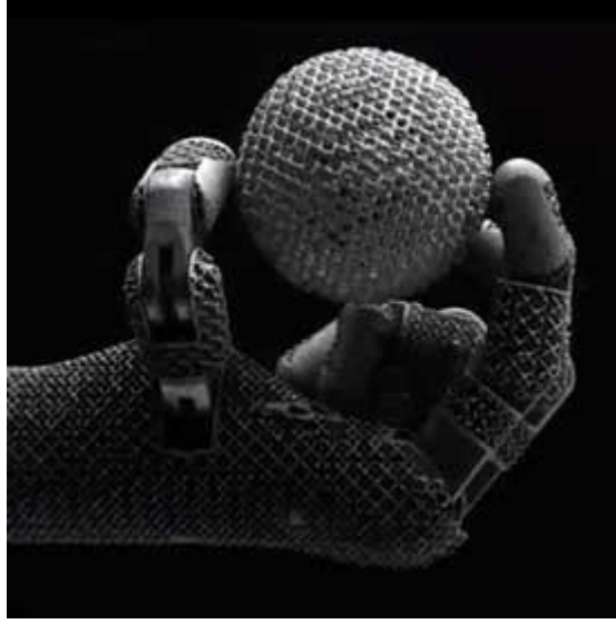
Şekil 4. 3D baskı robot el üretim çalışması [2]
