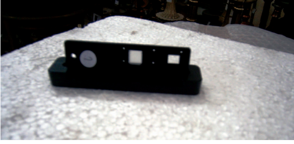
Şekil 5. İç ortama konulan MEMORI dozimetreleri: 1 numaralı dozimetre (solda), 2 numaralı dozimetre (sağda).
