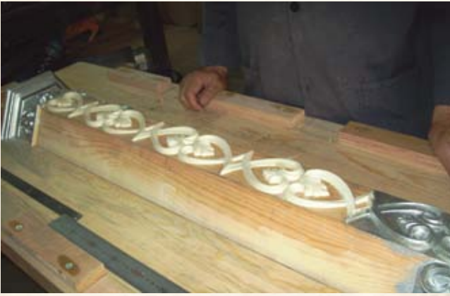
Resim,43-Eksik dökümler hazırlanan kalıplarla yeniden döküldü.
