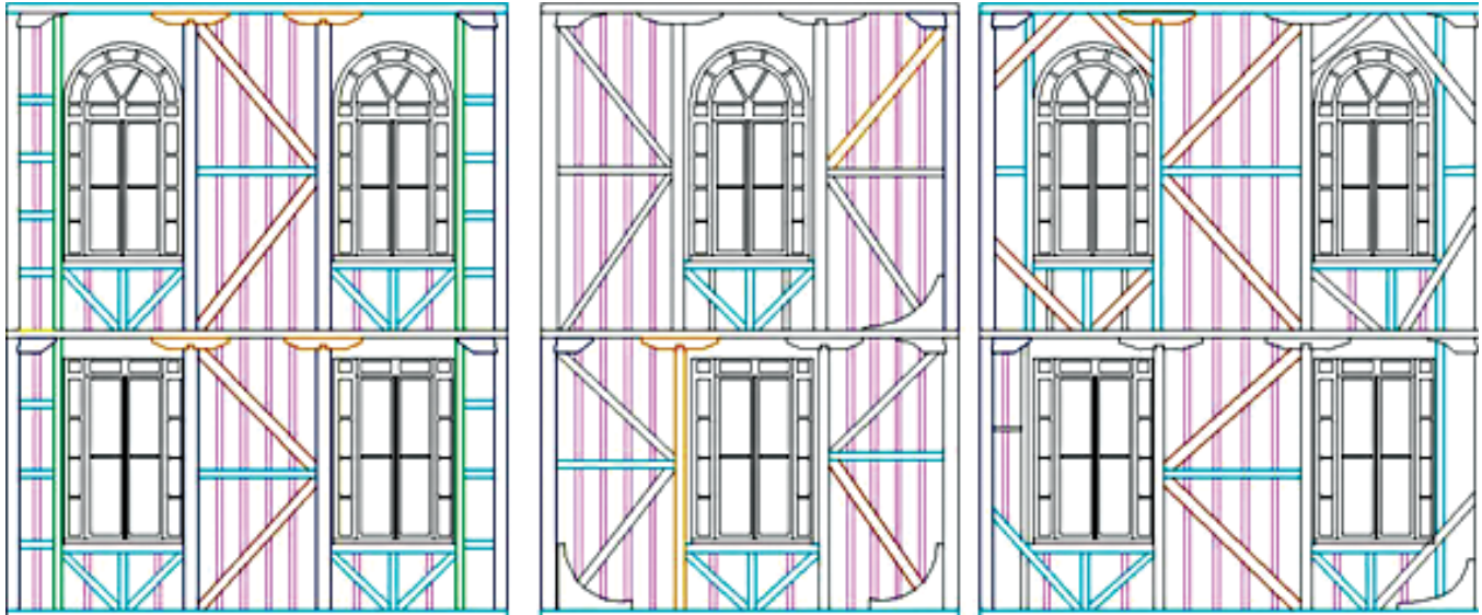
Çizim,11- Kuzey Cephesi Karkas Onarımı Uygulama Projesi
