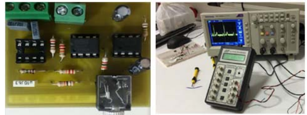
Şekil 5. Pcb(baskılı devre) dizaynı yapılmış ekg devresi görünümü ve analog uygulama çıkışı
