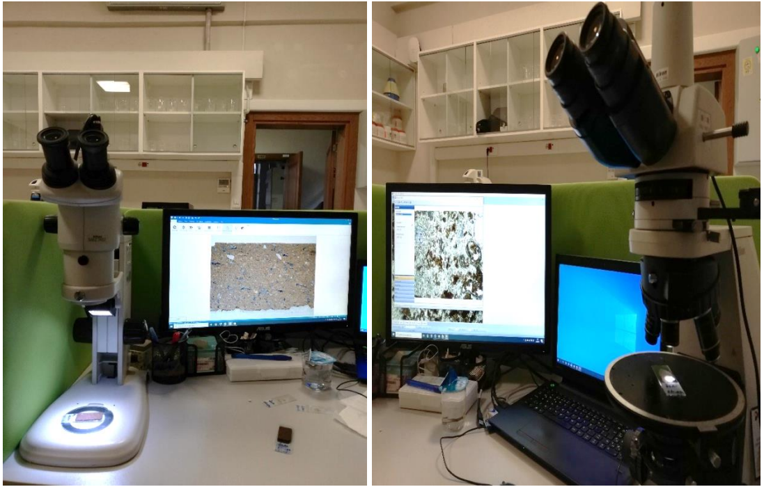
Şekil 2.15: Stereo mikroskop ve polarizon mikroskopta (ince kesit) incelemeler
