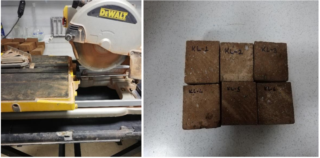
Şekil 2.18: Numunelerin boyutlandırılması ve hazırlanan küp numuneler
