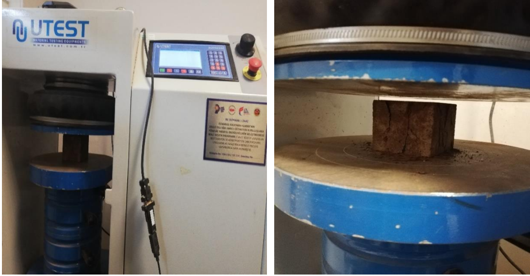
Şekil 2.22: Tek eksenli basın deneyi cihazı ve deney sonrası numune
