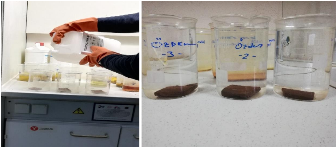
Şekil 2.7: Asitle muamele deneyi
