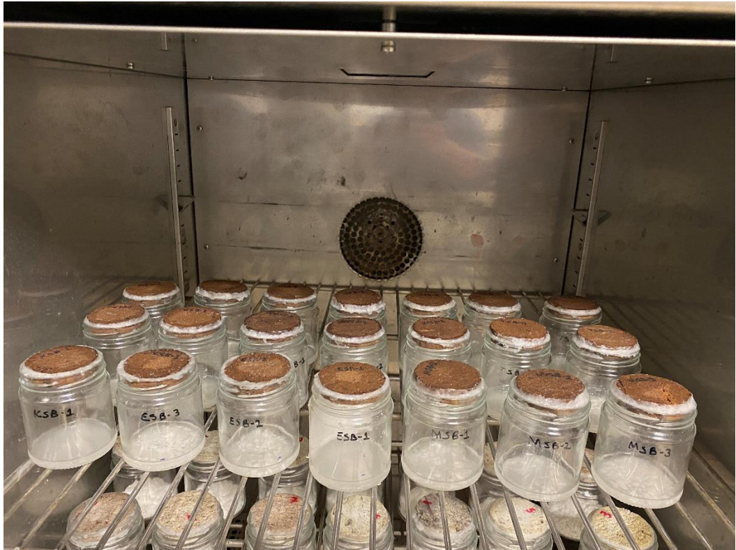
řekil 4.18: Deney sonucunda sıvı hale gelen CaCl_2
