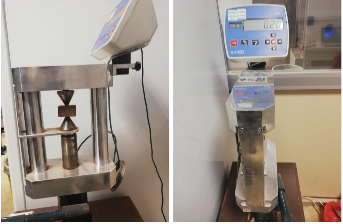
řekil 2.23: Nokta yk deneyi uygulaması
