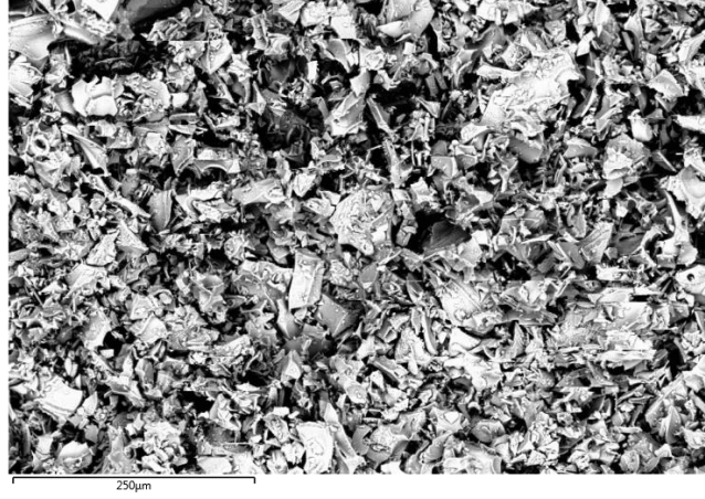
Şekil 2.10: Ahlat taşına ait SEM görüntüsü
