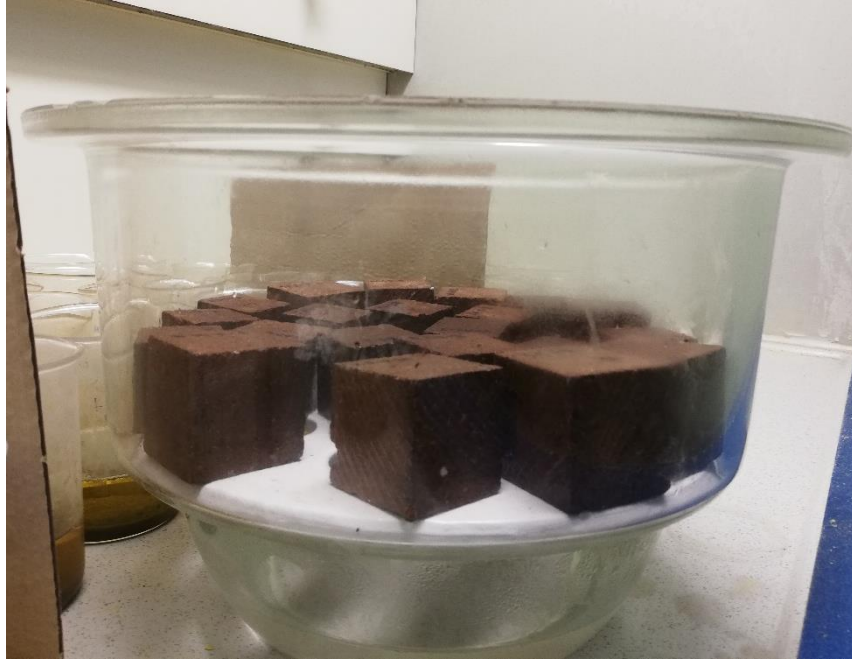
Şekil 5.15: Nemli ortamda SO 2 yıpratması deneyi
