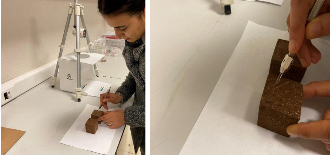
Şekil 2.21: Ahlat taşının Mohs sertliđinin belirlenmesi
