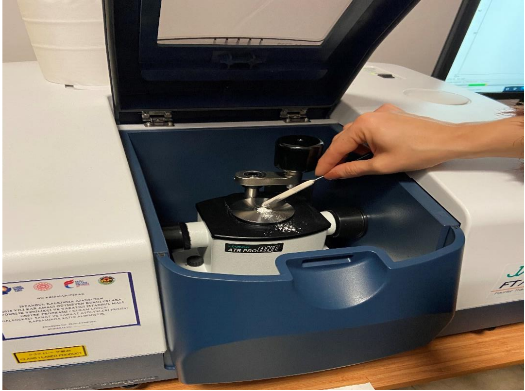
Şekil 2.13: FTIR cihazında analiz edilen numunenin konulması
