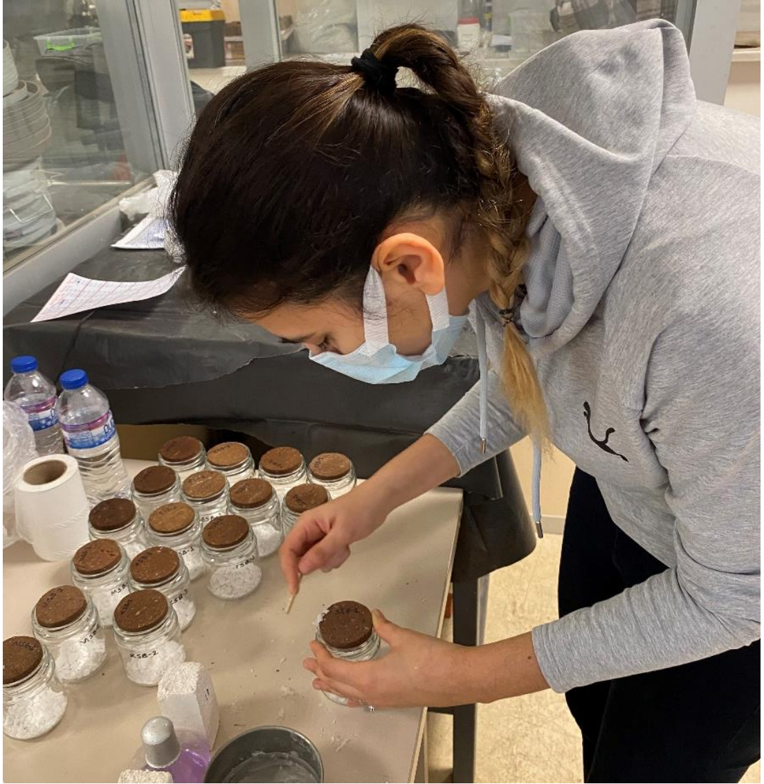
Şekil 4.16: Su buharı geçirgenliği deneyi için numunelerinin hazırlanması
