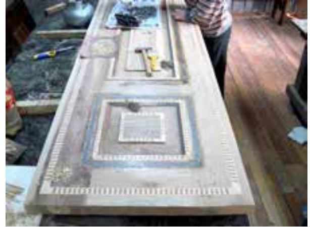
Fotoğraf 57,58. Marküteri tekniğinde eksik parçaların tamamlanması.
