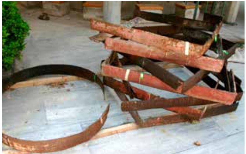
Fotoğraf 29-30. Sütun başlıklarında bulunan hasarlı çemberler.
