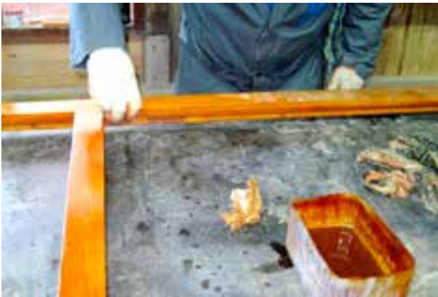
Fotoğraf 50-51-52. Yeni imal edilmiş doğramalar ve gomalak cila yapılması.
