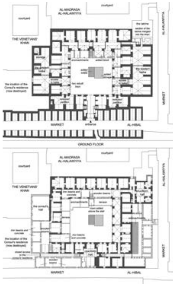
Plan 2. Han al Hibal'in 16. yüzyıl belgesindeki (Blg 1) ölçülere göre hazırlanan zemin ve 1. kat planları
