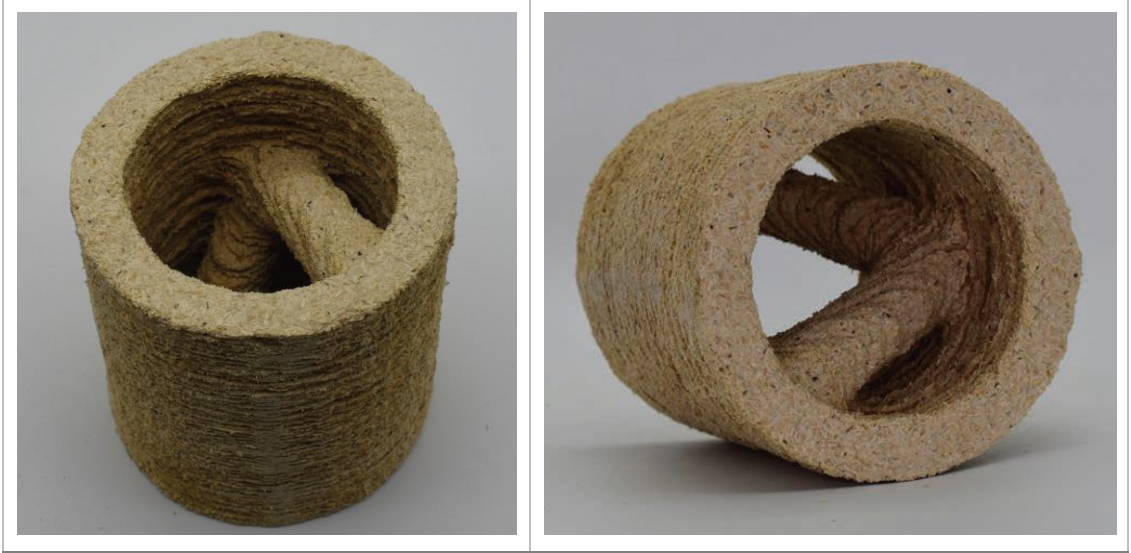
Şekil 2. 20 Bireysel katman imalatıyla yapısal kereste (ILF) (Talke, Buschmann, Saile, & Henke, 2021)
