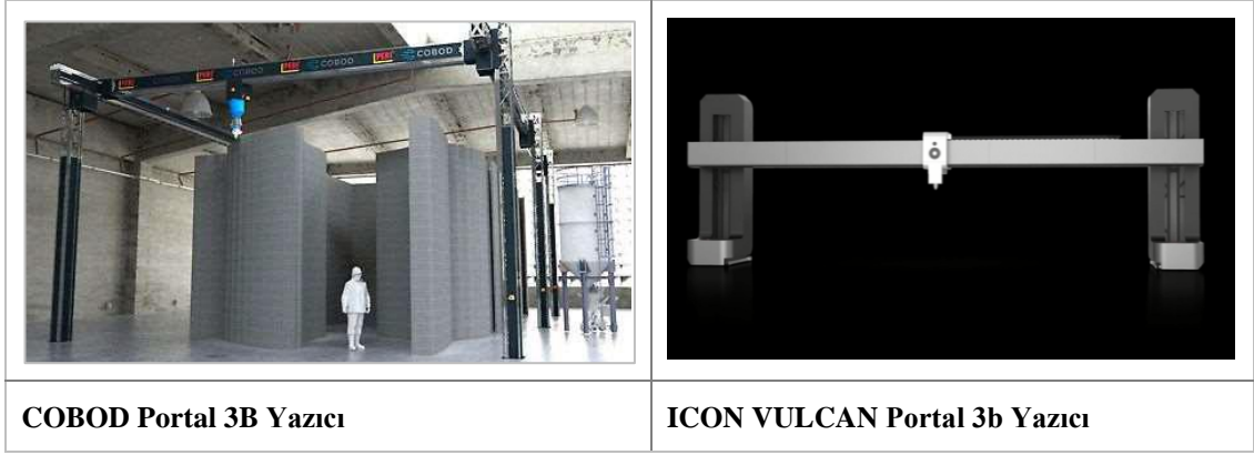
Şekil 2. 11 Kızaklı Sistem (Portal) 3B Yazıcılar (PERI, 2021).
