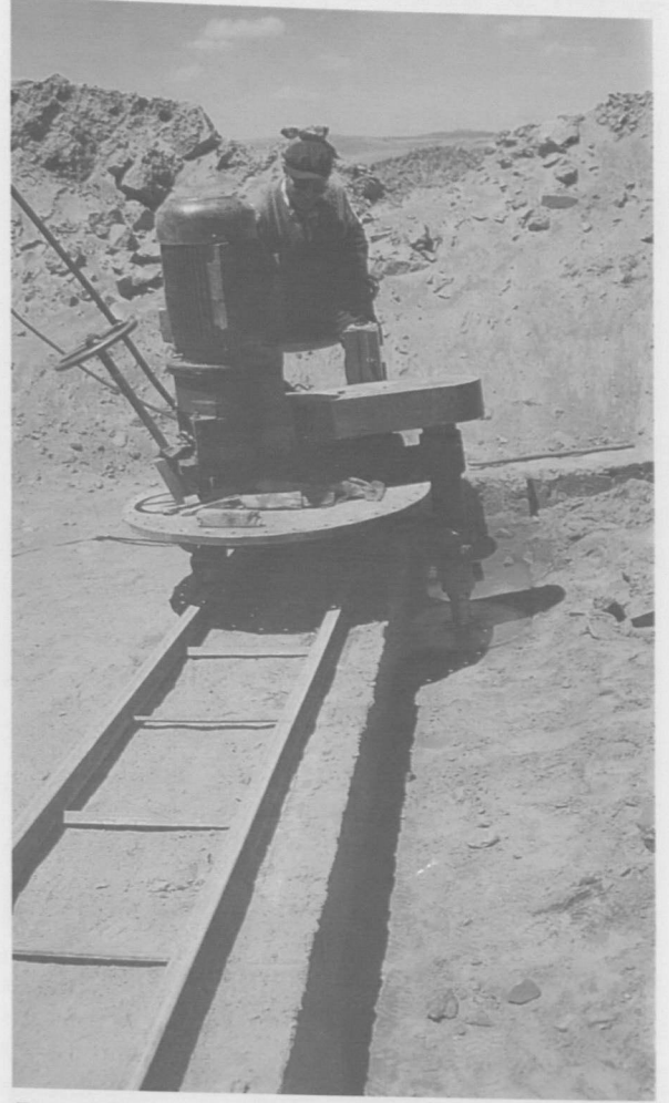
Res. 14: Ortakira Taş Ocağında taşın alt kısmının kesim sahnesi.
