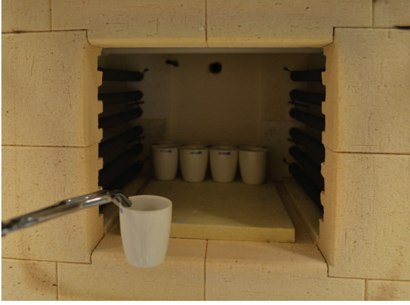
Fotoğraf 1. Kızdırma kaybı (kalsinasyon) analizi.
