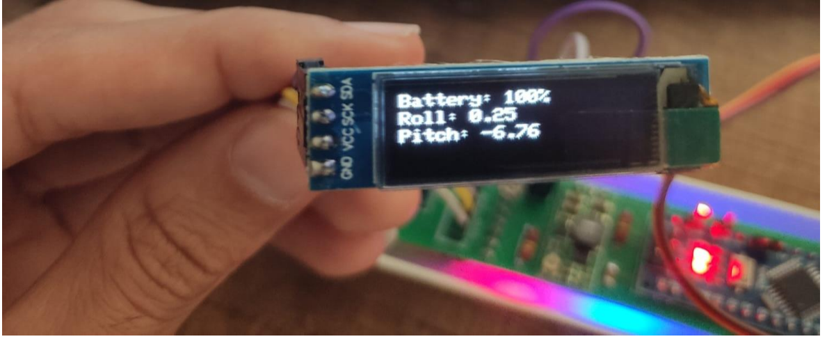
Şekil 2. 17 Roll ve pitch açısı gösterimi
