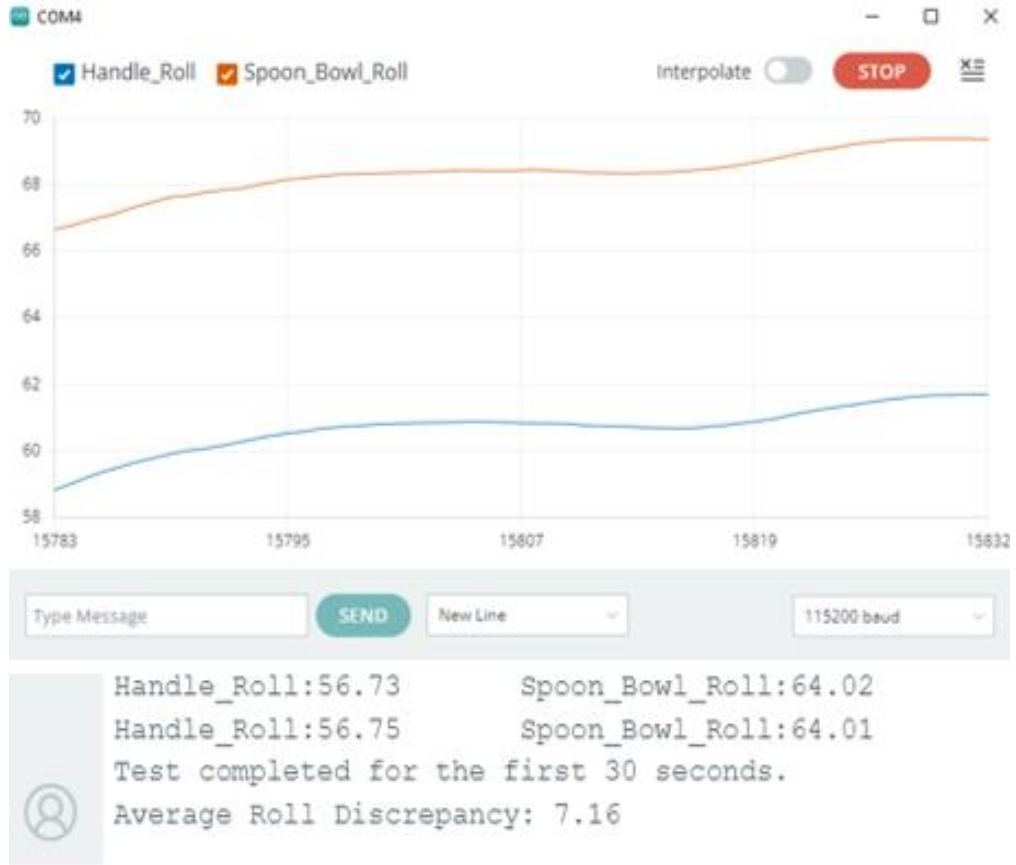
Şekil 3. 21: 20 gram pirinç ile yüklü kaşıқта yüksek titreşimde dönme hareketinin etkileri
