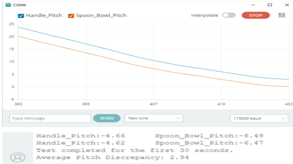
Şekil 3. 13 : 20 gram pirinç ile yüklü kaşıқта hafif titreşimde sallanma hareketinin etkileri
