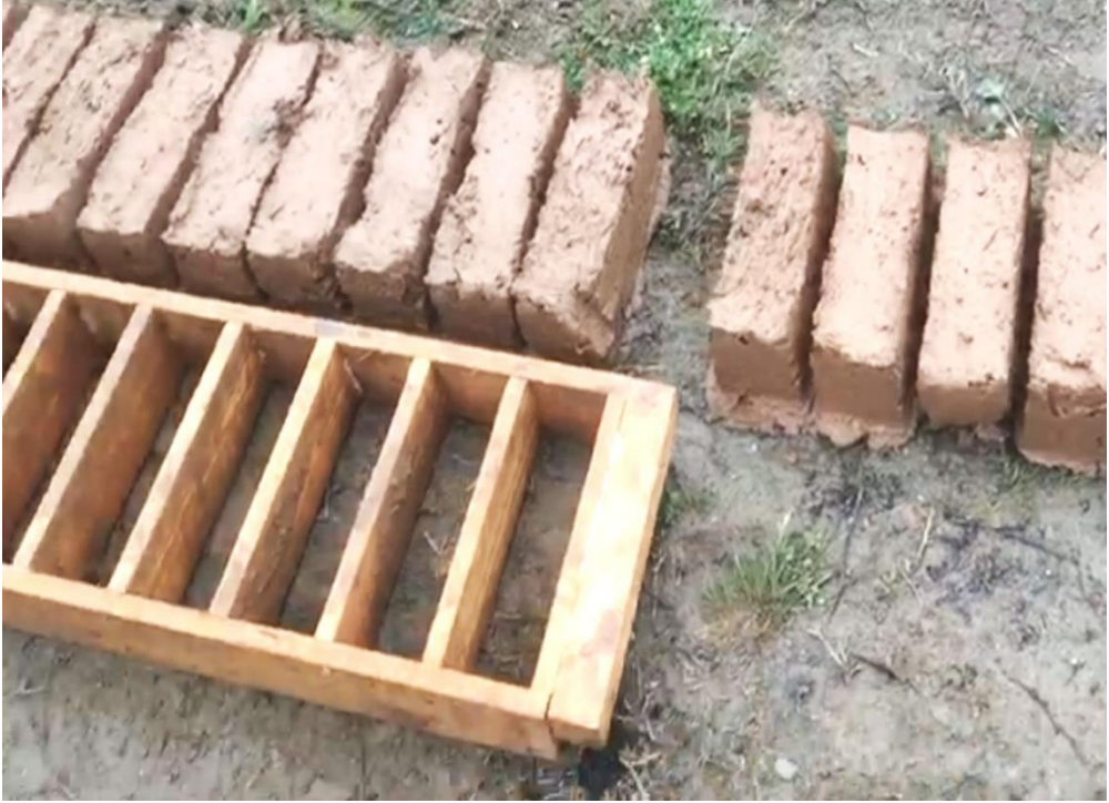
Resim 70 Kerpicin kalıptan çıktığı an
