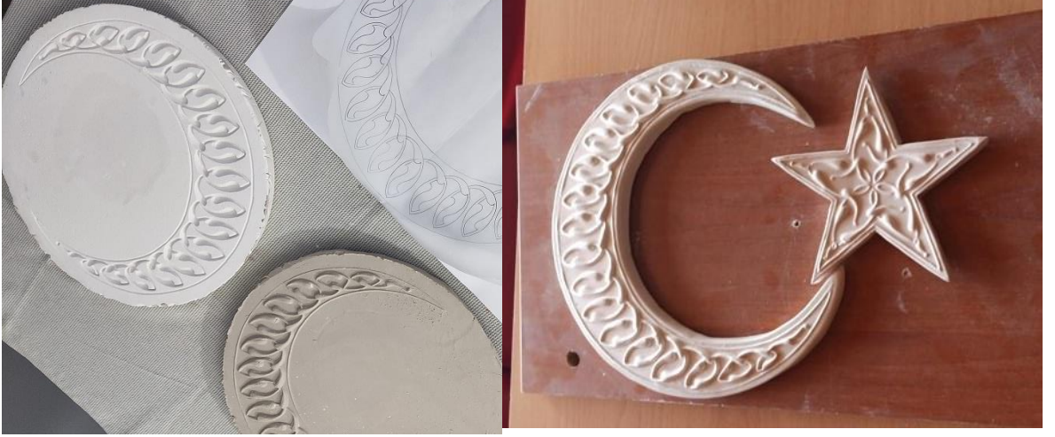
Alçı kalıp oluşturma, çamur basma, bisküvi pişirimi
