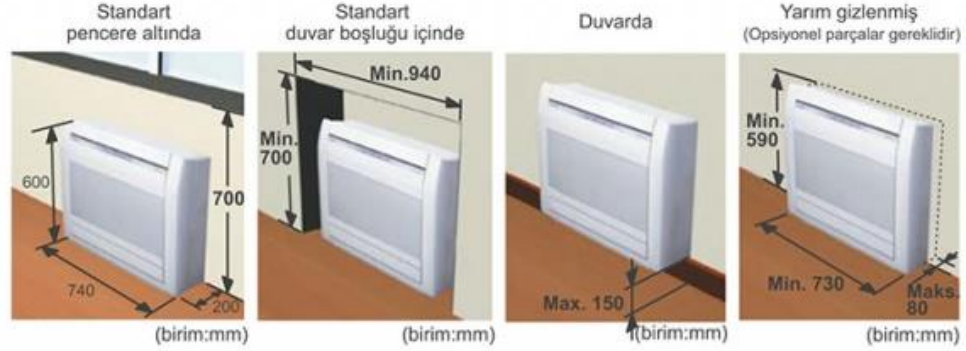
Şekil 3.22: Yer Tipi Split Klima Cihazı Montaj Seçenekleri (Fgeurope, 2017).
