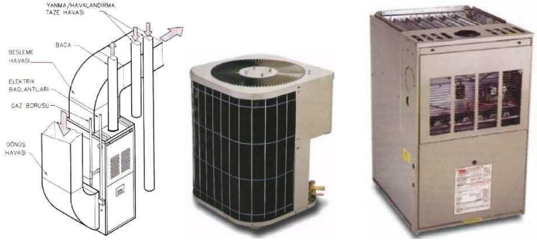
Şekil 3.28: Kanal Tipi Split Hava Isıtıcı Eklemeli Sistem ve Görseli (Anonim, 2001; Özcan, 2008).
