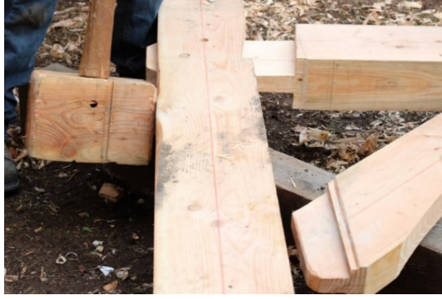
řekil 3.11: Ahřap bileřenlerin birleřtirilmesinde kullanılan ahřap balyoz.
