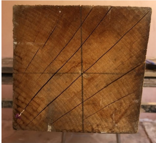
Şekil 3.1: Hızar kesiminin merkez hattına göre yamukluğu.
