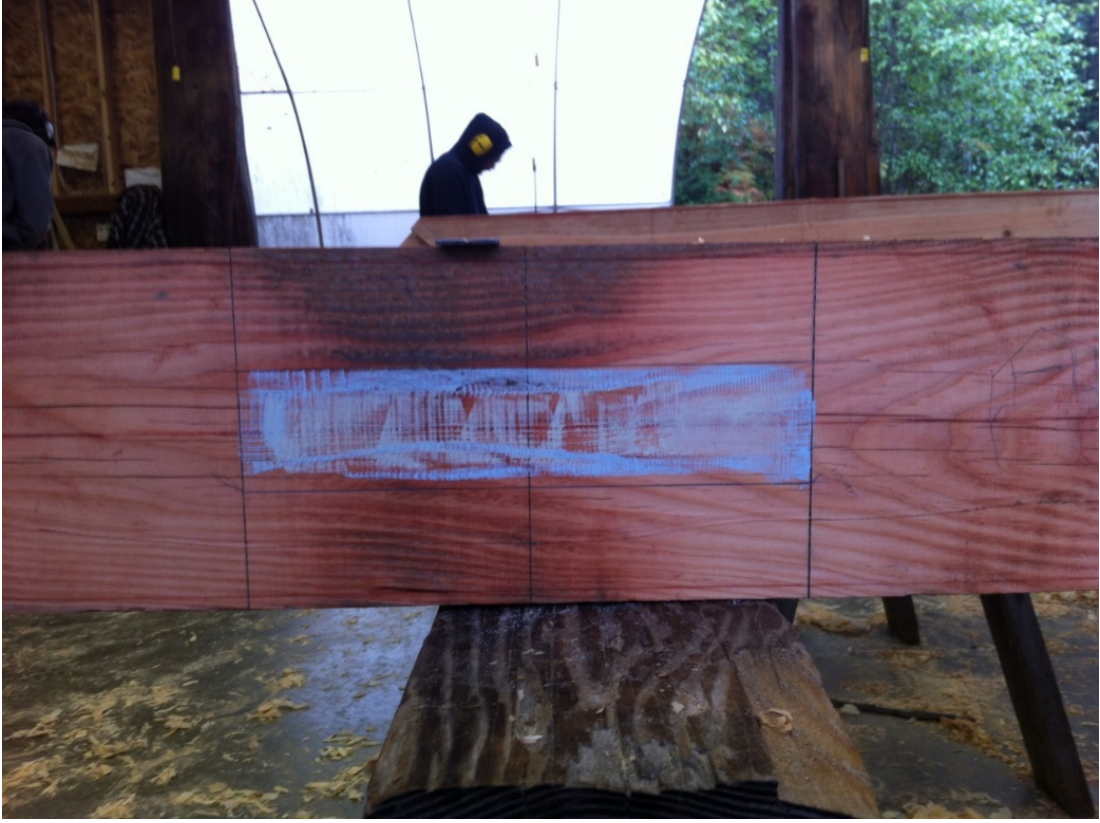
Şekil 4.8: Zıvana alanının işaretlenmesi ve boyanması.
