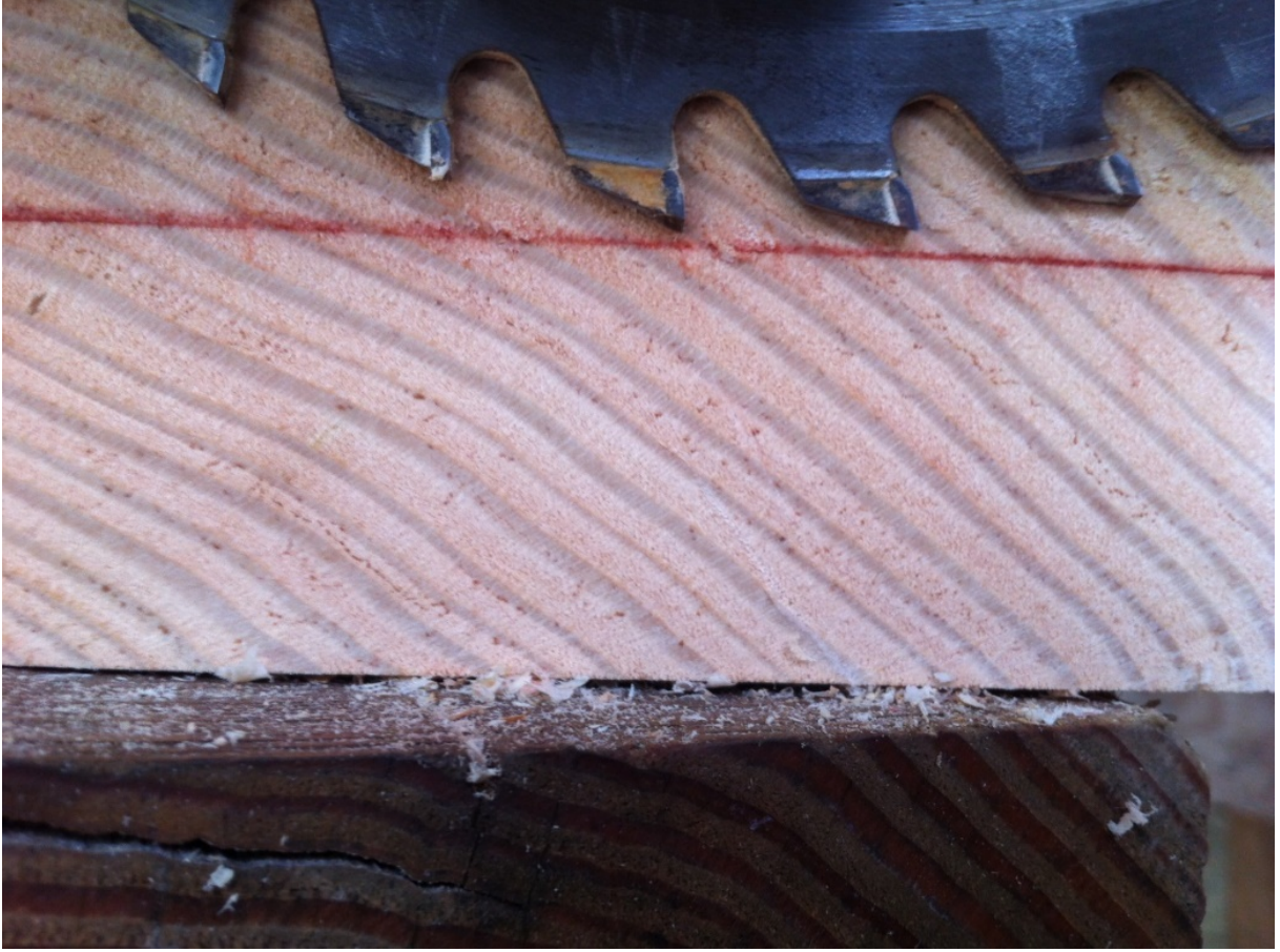
Şekil 4.11: Kesime başlanırken merkez hattı ile arada mesafe bırakılması.
