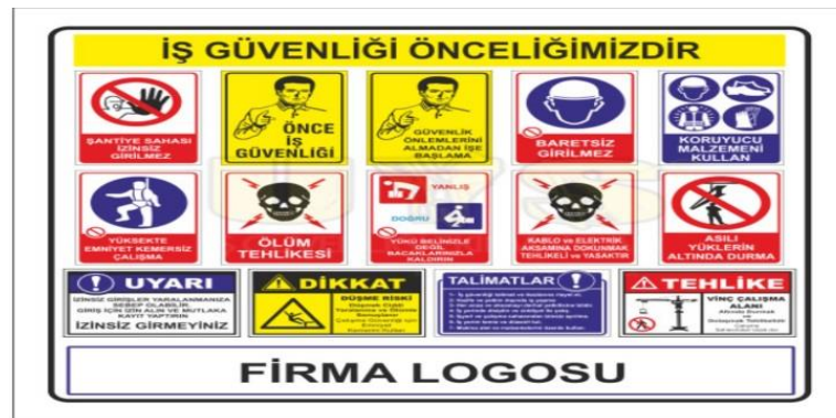
Resim 1.13: Şantiye iş güvenliği levhası (URL-14).
