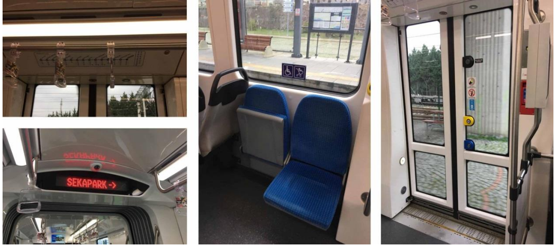
Resim 3.18: Tramvay kapısı, yardımcı araç ve gereç kullanımı için tasarlanmış alan, tramvay içi görsel bilgilendirme (Kaynak: Zeynep Canan Karagöz).
