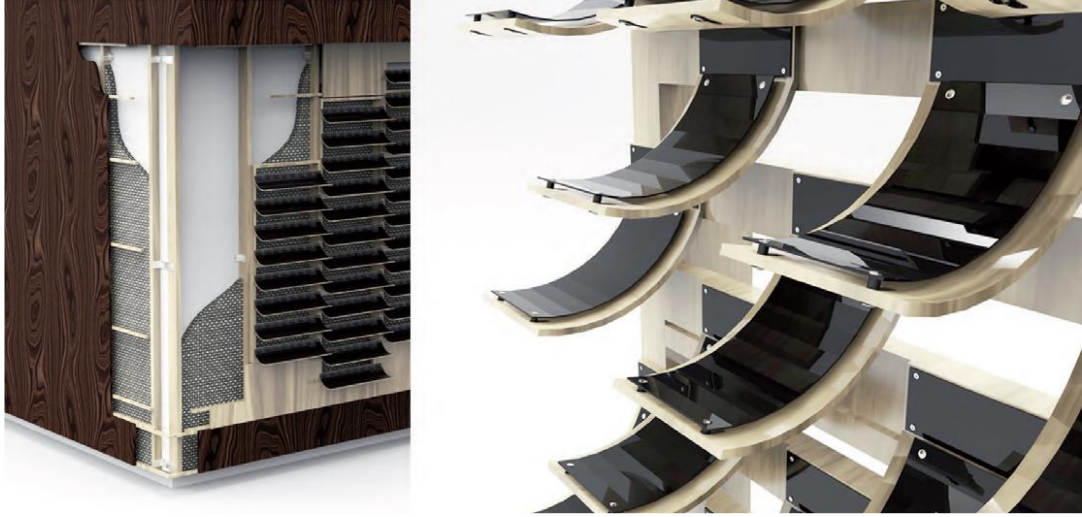
Şekil 5.9.1. Bina Entegre Fotovoltaik Panel Uygulaması
