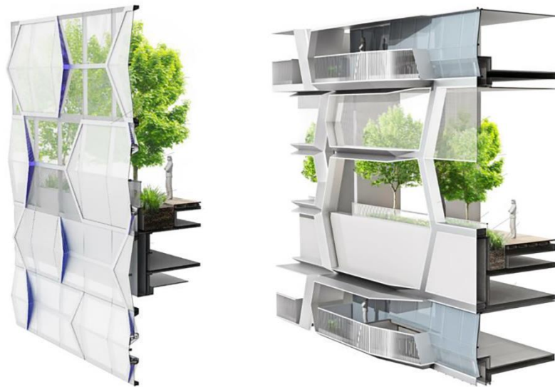
Şekil 4.3.1.2. V on Shenton Binası Çift Katmanlı Cephe Sistemi, Singapur, UN Studio (url 45)
