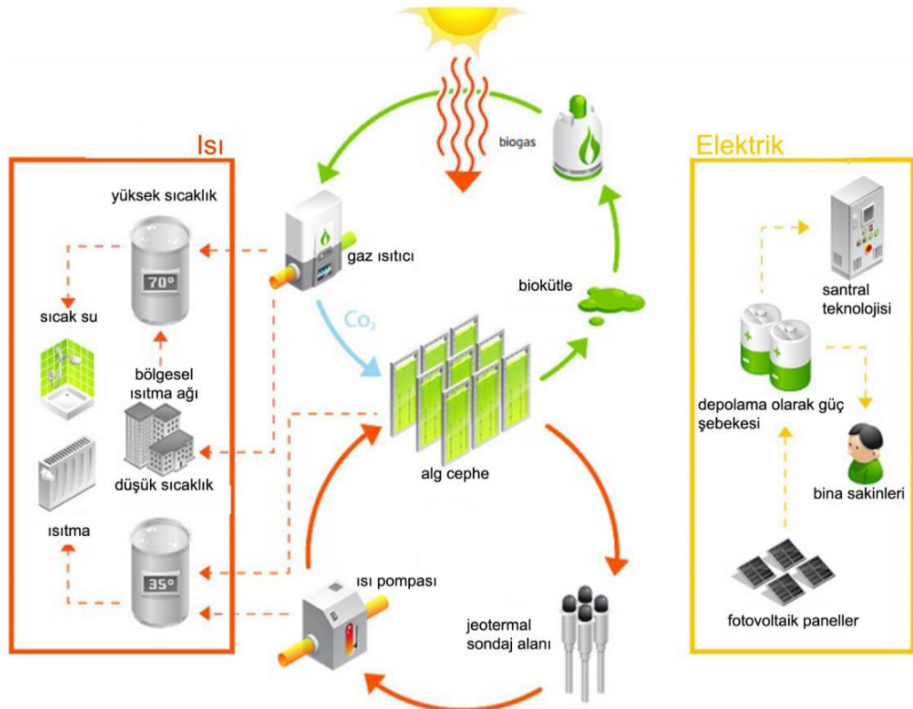
Şekil 5.12.3. Biyoreaktör Evi Çalışma Mekanizması (url 58)
