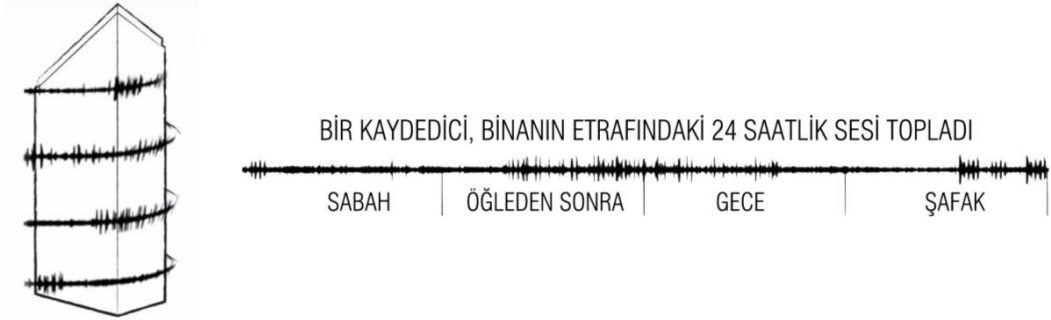
Şekil 4.3.4.1. Bina Etrafına Yerleştirilen Ses Sensörleri ile 24 Saat Yapılan Çevre Ses Kaydının Grafik Anlatımı, Hotel WZ Jardins, Brazil, 2015 (Requena, 2015)
