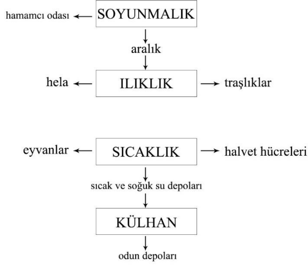
Şekil 21: Hamamı Oluşturan Mekânların Plan Şeması (Ş.Y.2020)
