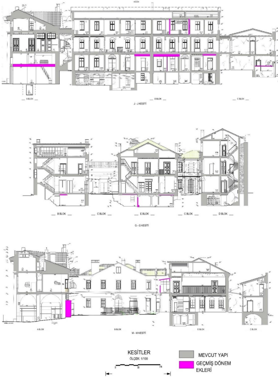
Şekil 5.14: Kesitler. İlgili kurumlardan elde edilen bilgiler doğrultusunda şematik olarak hazırlanmıştır. (Özbek, B.).
