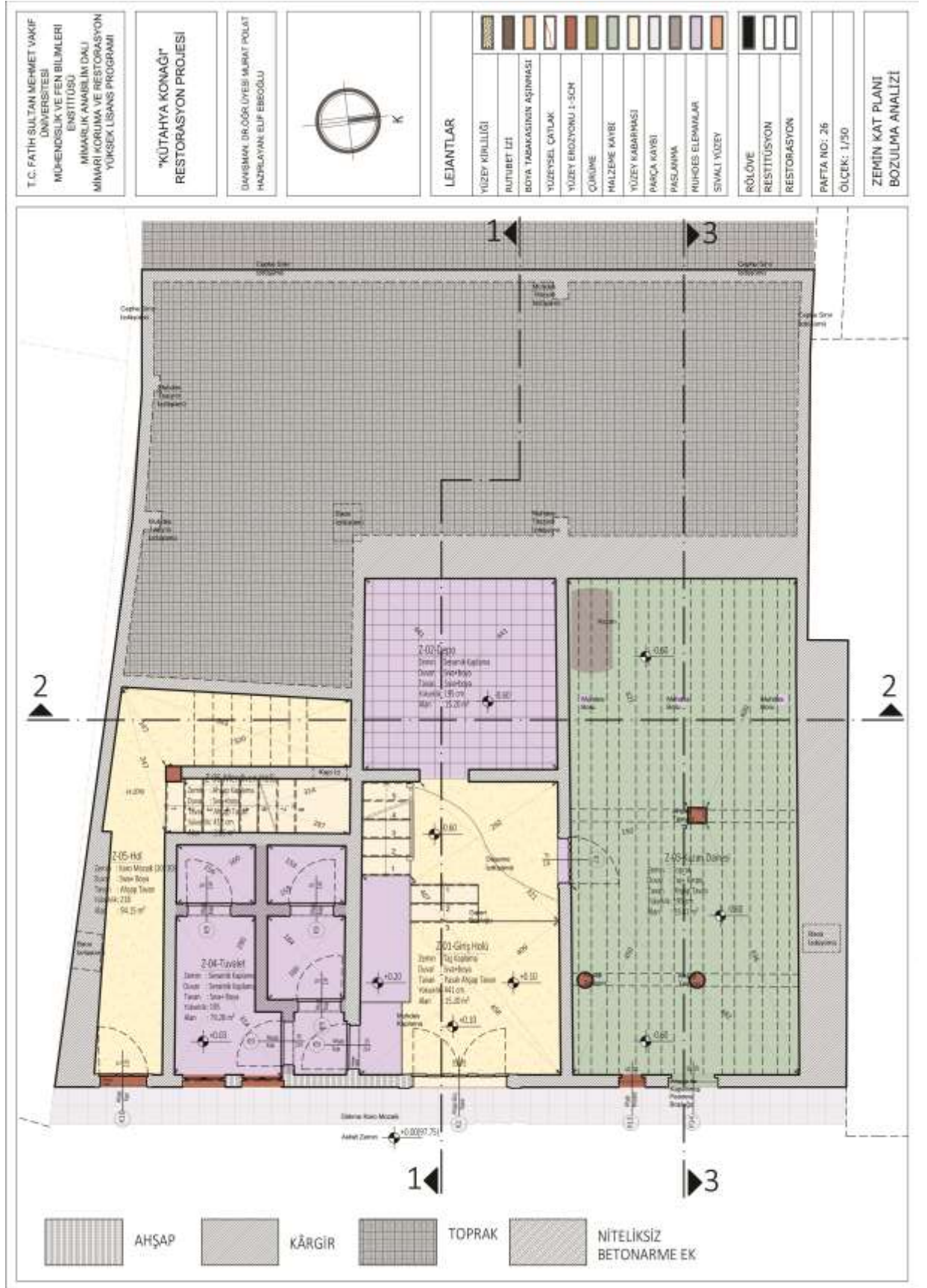
Çizim 26. Rölöve; Zemin Kat Planı Bozulma Analizi
