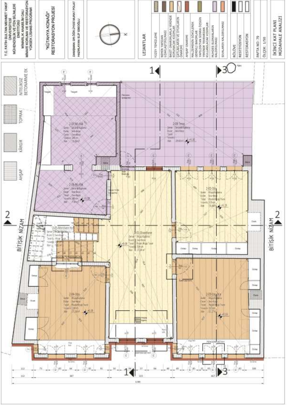
Çizim 79. Restorasyon; İkinci Kat Planı Müdahale Analizi
