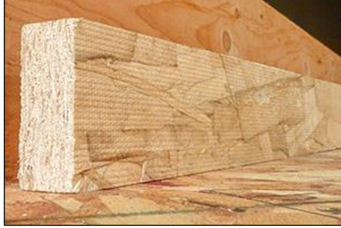
Resim 3-21: Yönlendirilmiş Yonga Ahşap (OSL) (Url-21).
