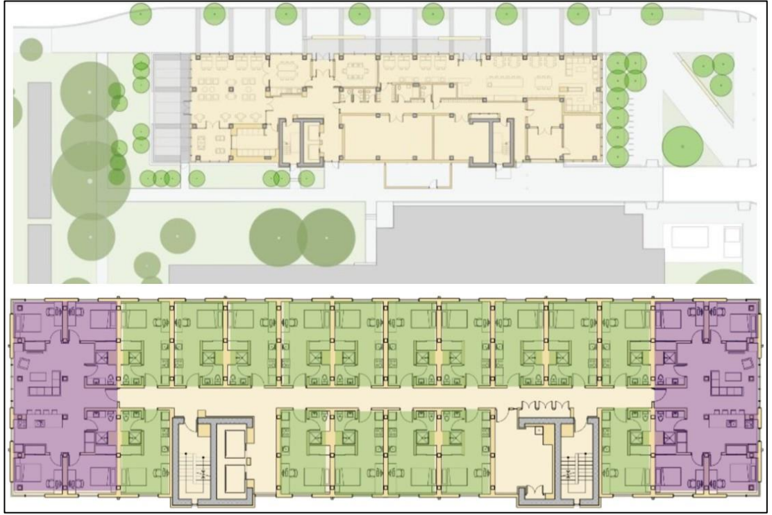
Şekil 4-11: Brock Commons, Zemin Katı ve Kat Planları (Url- 48), (Fallahi, 2017) (Mor alan dörtlü- yeşil alan tekli birimler)
