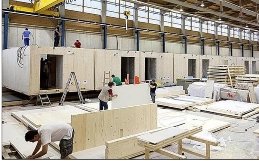
Resim 2-5: Ahşap Hacimsel Modüllerin Fabrika İmalatı (Wölfl, 2016).
