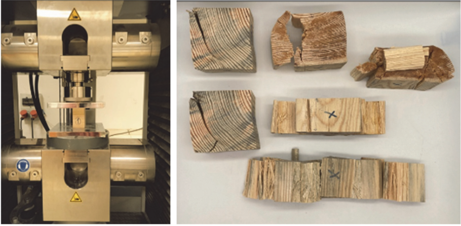
Şekil 9 - Liflere dik doğrultudaki basınç deneyi
