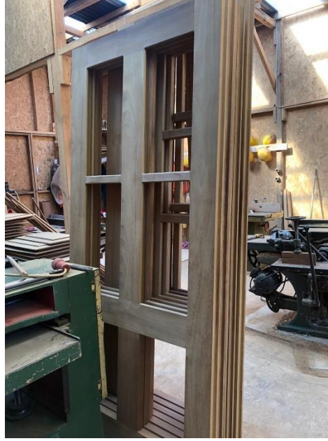
Şekil 6.163. Yapının Güney ve Kuzey cephelerindeki tek kanatlı giriş kapılarının yeniden yapımı görülmektedir.
