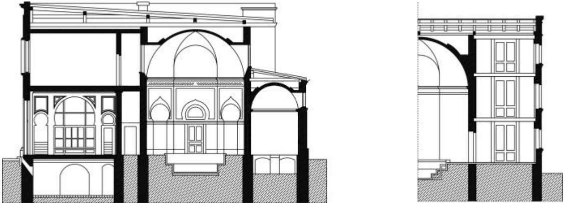
Şekil 3.1.10: Bölümler; İsa Bey Hamamı'nın J. Vancaş projesinden kesitleri (Saraybosna Kentsel Planlama Enstitüsü).
