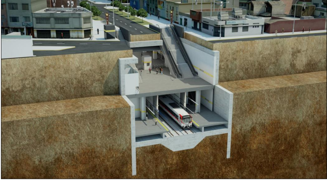
Şekil 14: Aç-Kapa Yapım Yöntemi (Url-8).
