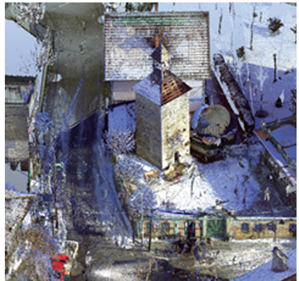
Şekil 1. Yapının optik ve scanner sistem ile ölçümü.
