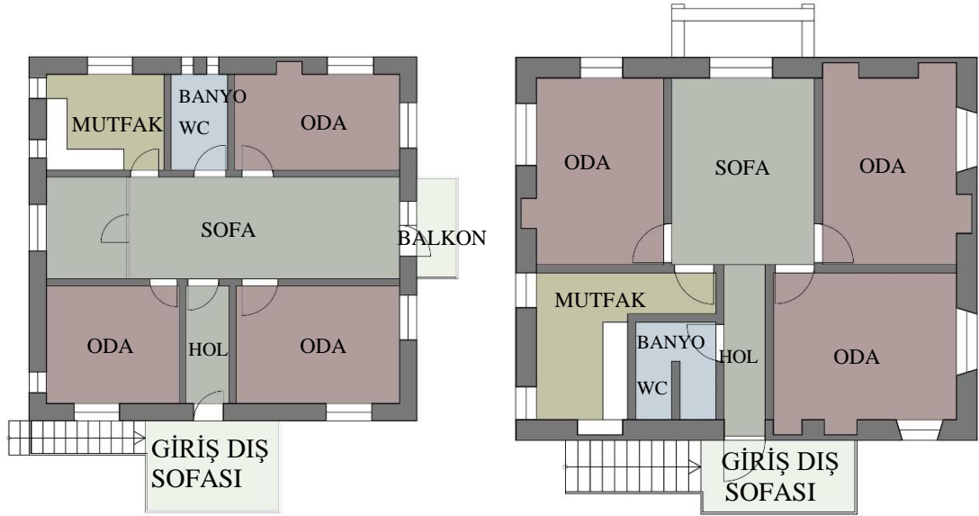
Şekil 5.59 5 ve 19 envanter numaralı konutların birinci kat planları. Islak hacimleri birinci kata eklenen konut örnekleri (2020)
