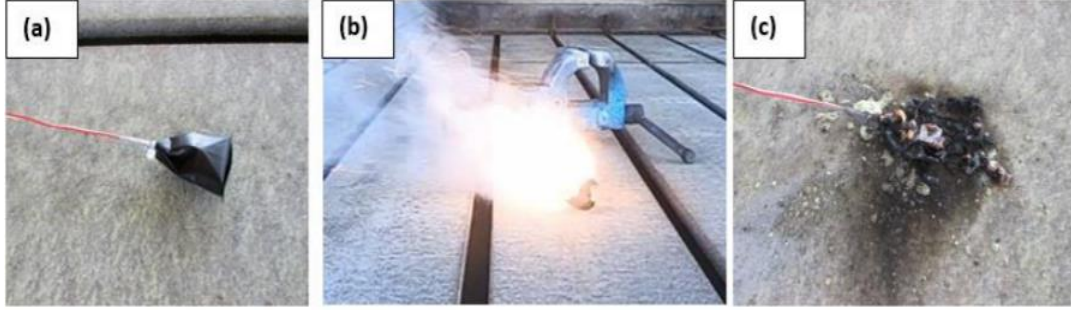
Resim 55 : Yanma testi: (a) test öncesi, (b) yanma sırasında, (c) test sonrası
