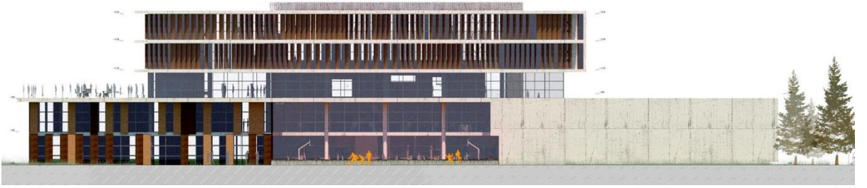
Şekil 4.128. Özel İAOSB Nedim Uysal MTAL doğu cephesinde güneş kırıcılar (URL-51).
