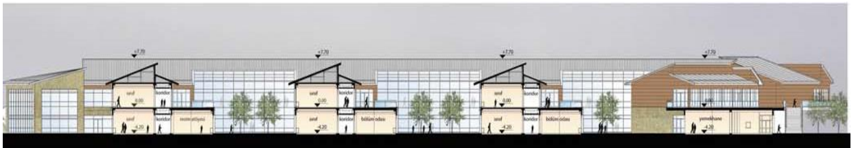
Şekil 4.36. Galeri ve sınıf birimleri bağlantısını gösteren ilköğretim binası kesiti (Sepin Mimarlık Proje Arşivi).
