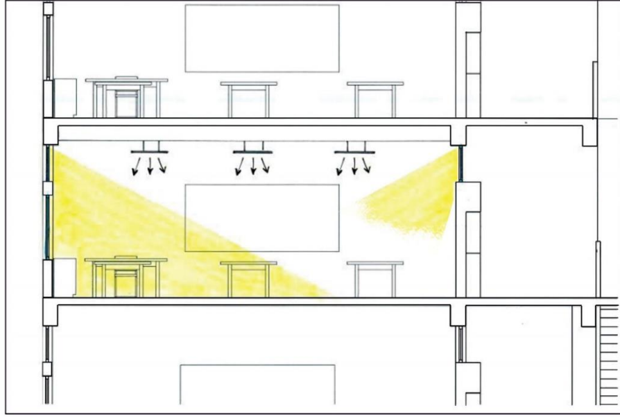
Şekil 4.11. Dersliklerde pencere ve aydınlatma prensipleri (Yöntem, 2016).
