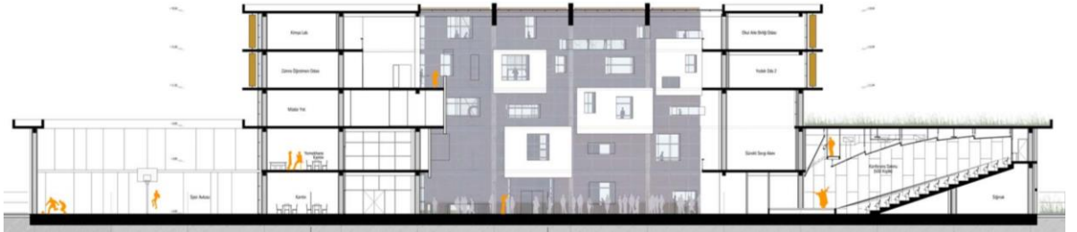
Şekil 4.133. Özel İAOSB Nedim Uysal MTAL Lisesi galeride cam tavanı gösteren kesit (URL-50).
