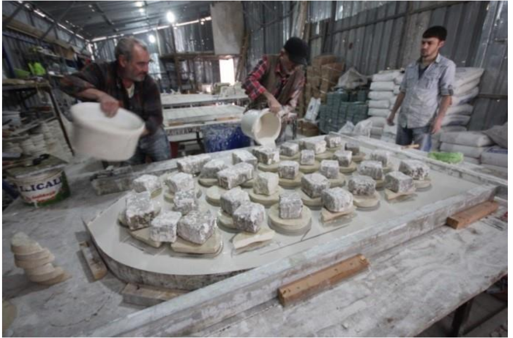
Fotoğraf 4. 89. Tatlı kireç harcının hazırlanan kalıba dökülmesi (A.ASLAN)
