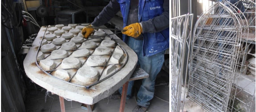
Fotoğraf 4. 87.Dışlık pencereler için hazırlanan paslanmaz çelik donatı (A.ASLAN)
