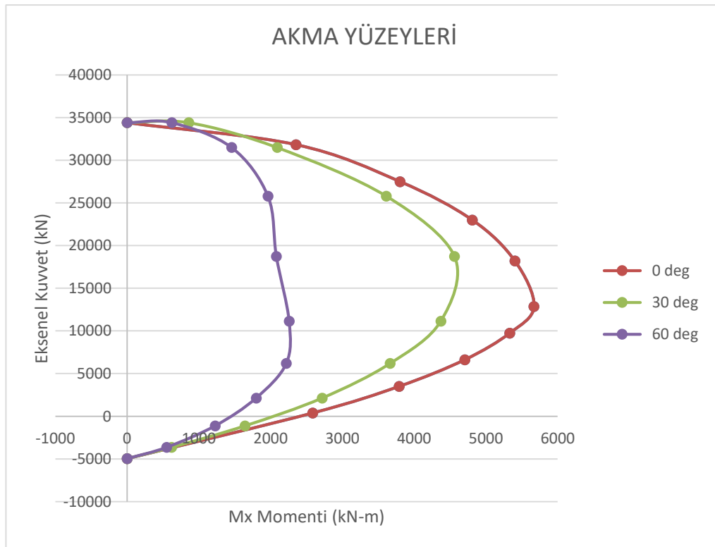
Şekil 3.38: Kolon Akma Yüzeyleri.
