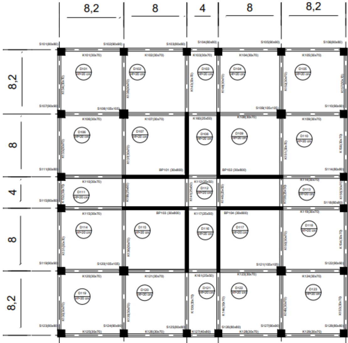
Şekil 3.1: 21 Katlı Binanın Birinci Kat Kalıp Planı
