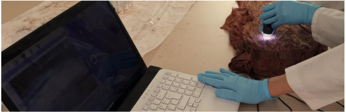
F.133. USB Portatif mikroskop ile tekstil eserde dokumanın görüntülenmesi (Ayşe TEPEYURT MEREV 2016)
