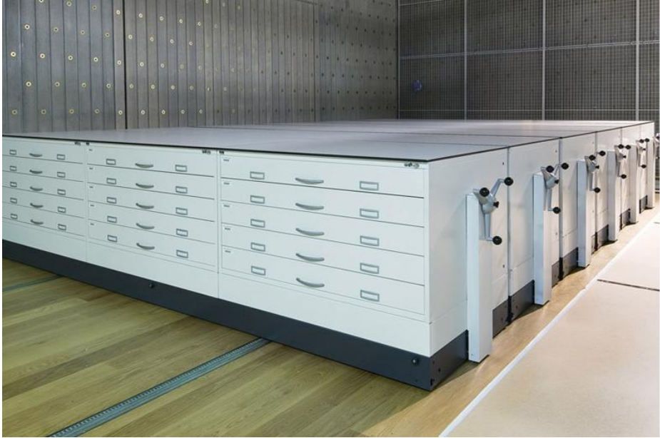
F.118. Günümüzde depolarda kullanılan kompakt çekmeceli modern depo dolapları
