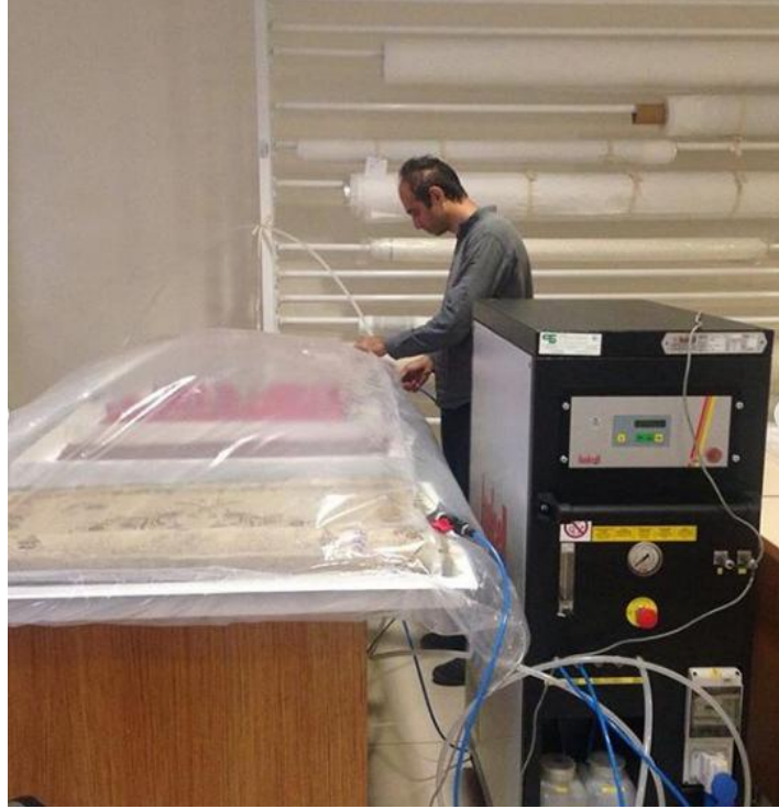
F.74. İstanbul Restorasyon Merkez Laboratuvarı'nda tekstil esere azot gazı ile polietilen yalıtım kullanılarak modifiye atmosfer metodunun uygulanması (Ayşe Tepeyurt Merev 2018)
