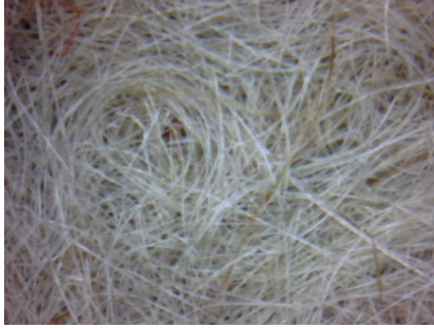
F.19. Keçenin mikroskop altında görüntüsü(İRKML Arşivi)
