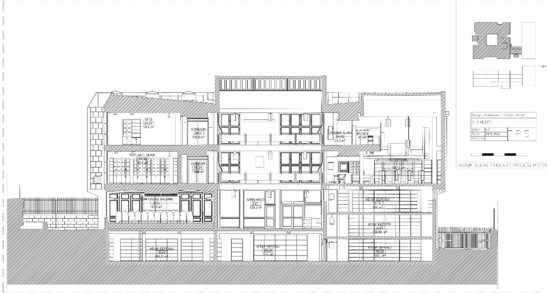
Şekil 2.29: TTK Binası'na ait 3-3 kesiti
