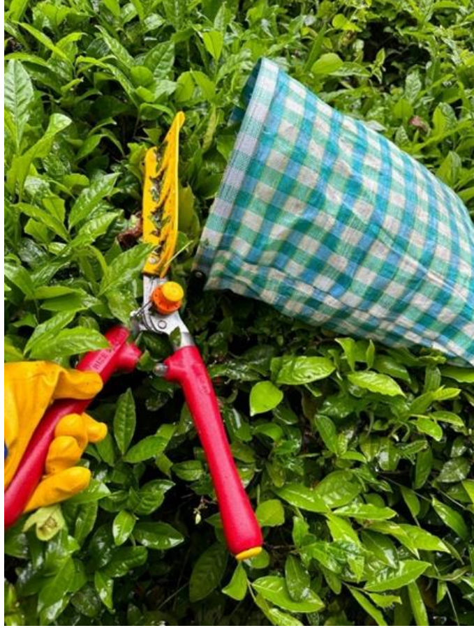
Fotoğraf 1: Mekanik Yaş çay toplama makası (Zerdeci, 2024).
