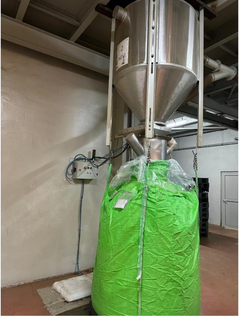
Fotoğraf 15: Depoya Gnderilmek İin Hazırlanan Jumbo Paketleme (Zerdeci, 2024).
