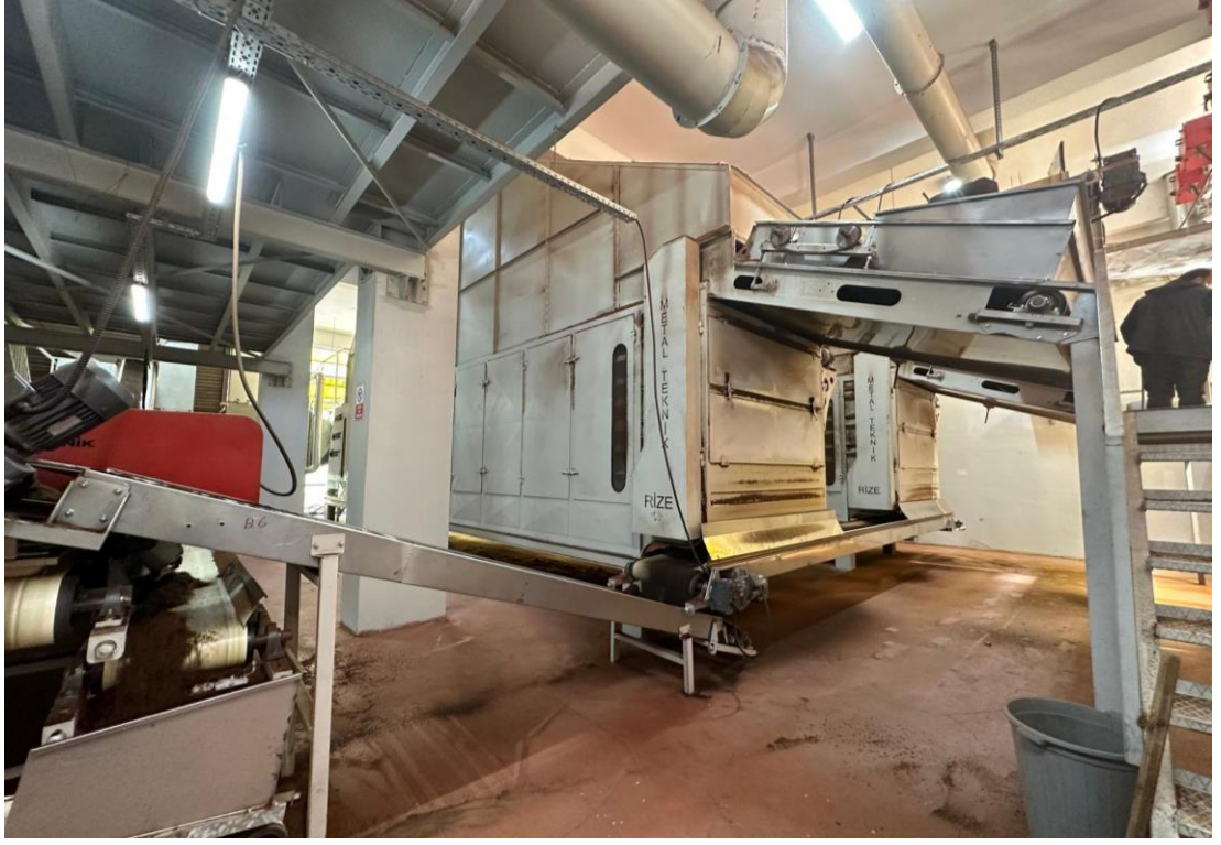
Fotoğraf 11: Kurutma Prosesinde Kullanılan Fırınlr (Zerdeci, 2024).
