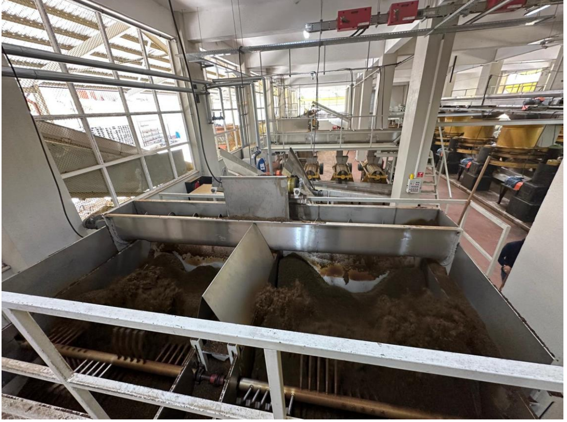
Fotoğraf 9: Fermantasyona Girmeden Önce Karıştırılarak Giren Çaylar (Zerdeci, 2024).
