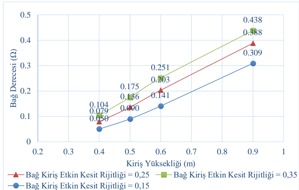
Şekil 4.32: Bağ kiriş yüksekliği – bağ derecesi katsayısı (perdenin plandaki uzunluğu a = 4\text{m} ve bağ kirişin plandaki uzunluğu l = 4\text{m} , kat adedi = 6 kat).
