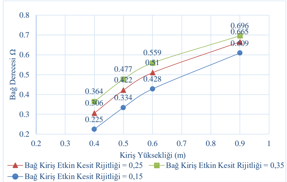
Şekil 4.12: Bağ kiriş yüksekliği – bağ derecesi katsayısı (perdenin plandaki uzunluğu a = 3\text{m} ve bağ kirişin plandaki uzunluğu l = 3\text{m} , kat adedi = 8 kat).
