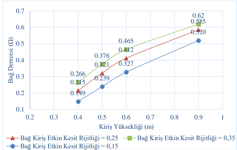
Şekil 4.30: Bağ kiriş yüksekliği – bağ derecesi katsayısı (perdenin plandaki uzunluğu a = 4 m ve bağ kirişin plandaki uzunluğu l = 3 m, kat adedi = 8 kat).
