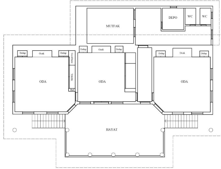
Şekil 1.11 : Nuzhet Sürücü Evi yaşam katı planı. (Öncü Başoğlan Avşar'a ait makaleden faydalanılarak tekrar çizilmiştir.)
