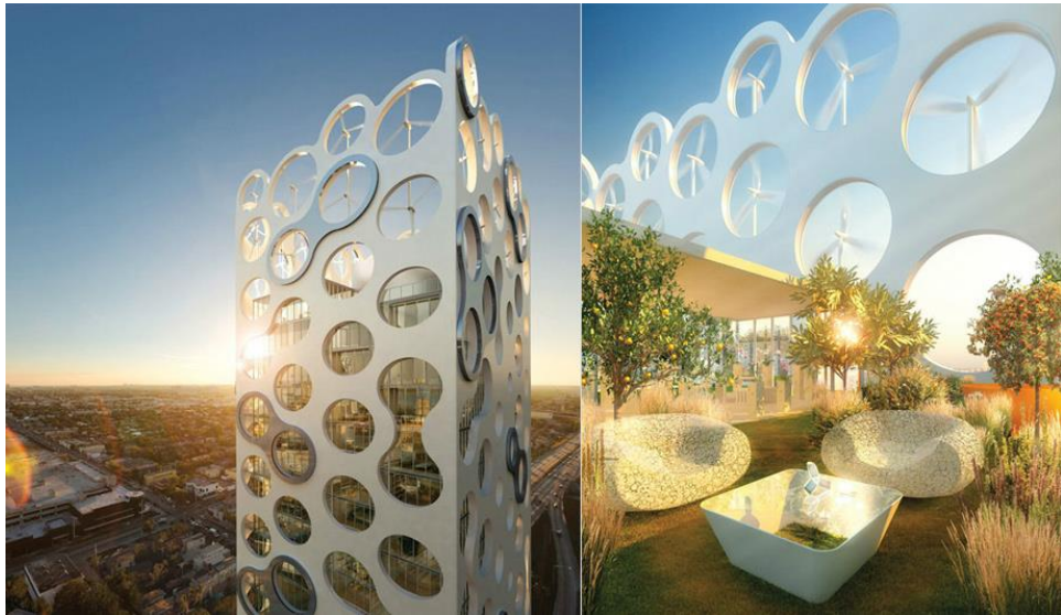
Şekil 1.17: Binaya entegre edilmiş rüzgâr türbinleri örneği: COR, Oppenheim Architects (Url-17).
