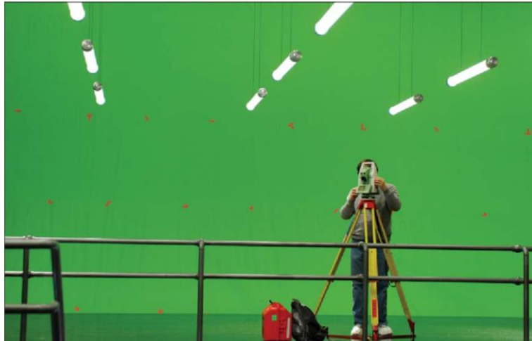
Şekil 2.65: Mo-Sys'in Startracker Tavan İşaretleyicileri Ve Sensör Sistemi (Tornberg ve Wennstrom, 2017)
