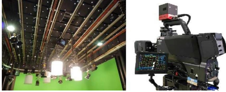
Şekil 2.65: Mo-Sys'in Startracker Tavan İşaretleyicileri Ve Sensör Sistemi (Tornberg ve Wennstrom, 2017)
