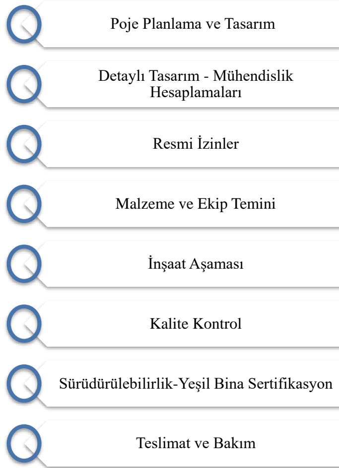
Şekil 4.2. Yapı Üretim Sürecinin Basamakları
