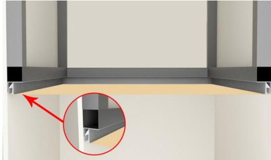
Şekil 3. 16 : Gerilmiş tavan sistem detayı ( Url-16).
