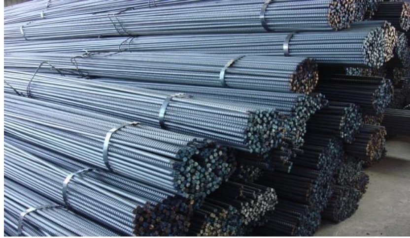
Şekil 2. 9 :Donatı çeliği; betonarme yapıların dayanıklılığını artırmak için kullanılan (Url-8).
