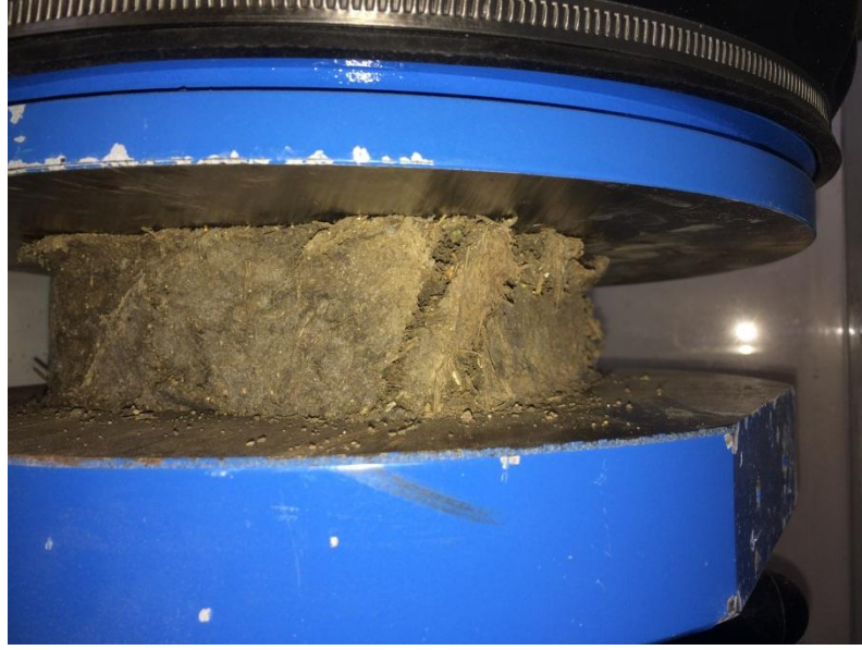
Resim 6.34: Basınç dayanımı test cihazı altında Pirinç samanı kerpiç örneği, "örnek No. 2", (Türkiye, FSMV Üniversitesi, KURAM Laboratuvarı)
