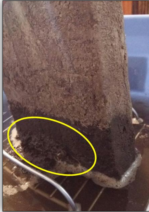
Resim 6.18: Hurma yaprađı katkılı numune, Arka taraftaki su seviyesinde basit bir artışla birlikte köpüklenmenin nispeten devam etmesi. (Rasha ELBORGY)
