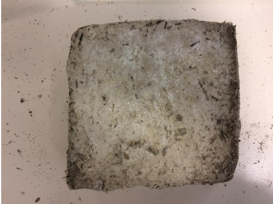
Şekil 6.17: 7 * 7 * 7 cm boyutundaki pirinc samanı ve hurma yaprağı dört adet kerpiç numunesinin basınç dayanım testi sonucu. (Rasha ELBORG Y)
