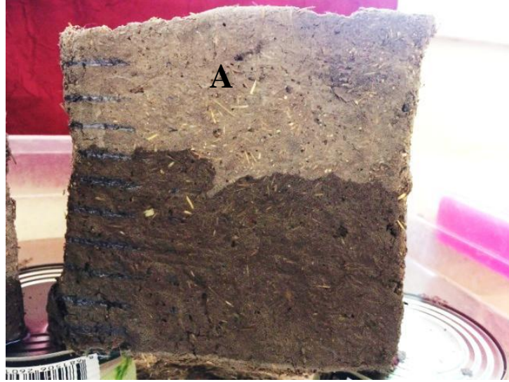
Resim 6.23: Deneyin başlamasından bir saat sonra, Pirinçten yapılan kerpicin, Saat 13:00'da su emme derecesi. A. Pirinç samanı kerpiç. (Rasha ELBORGY)
