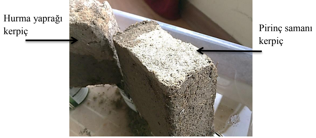
Resim 6.28: Pirinç samanından yapılan kerpiçlerin su emmesi Saat 18:50 (Rasha ELBORGY)
