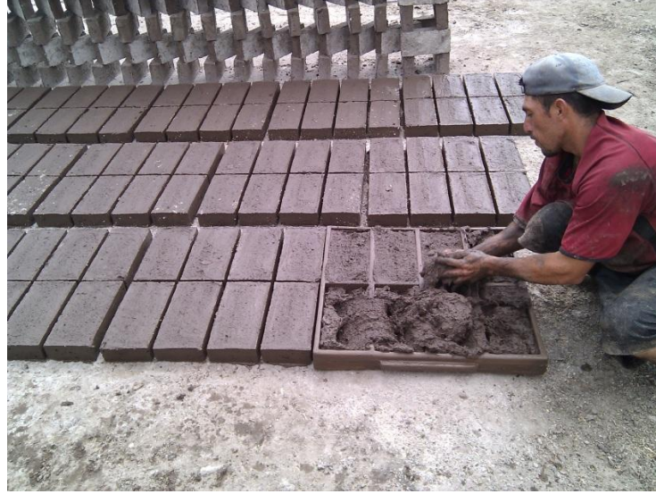
Resim 3.5: Kerpiç Kalıplama İşlemi (URL5)
