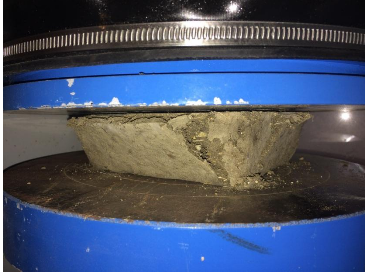
Resim 6.32: Basınç dayanımı test cihazı altında Hurma yaprağı kerpiç örneği, "örnek No. 7", (Türkiye, FSMV Üniversitesi, KURAM Laboratuvarı)
