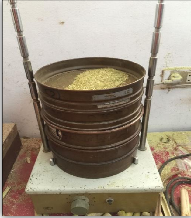
Resim 6.5: İyice doğranıp elekten geçirilmiş hurma yaprakları. (Mısır, İskenderiye Üniversitesi Ziraat Fakültesi Laboratuvarı)
