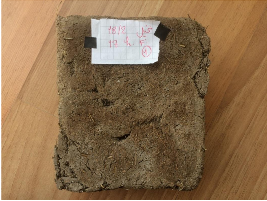
Resim 6.12: Hurma yaprağı ve Pirinç samanı Kerpiç Numune, A. Pirinç samanı kerpiç, B. Hurma yaprağı kerpiç. (Rasha ELBORGY)
