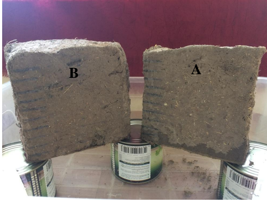
Resim 6.20: Hurma yaprağı ve pirinç samanı Kerpiç numuneleri karşılaştırılması Saat 12:00 testin başlangıcında, A. Pirinç samanı kerpiç, B. Hurma yaprağı kerpiç. (Rasha ELBORGY)
