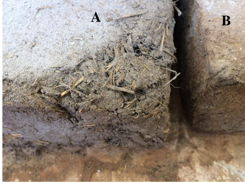
Resim 6.12: Hurma yaprağı ve Pirinç samanı Kerpiç Numune, A. Pirinç samanı kerpiç, B. Hurma yaprağı kerpiç. (Rasha ELBORGY)
