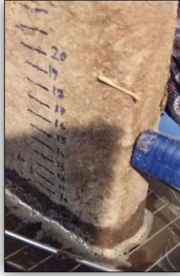
Resim 6.18: Hurma yaprađı katkılı numune, Arka taraftaki su seviyesinde basit bir artışla birlikte köpüklenmenin nispeten devam etmesi. (Rasha ELBORGY)
