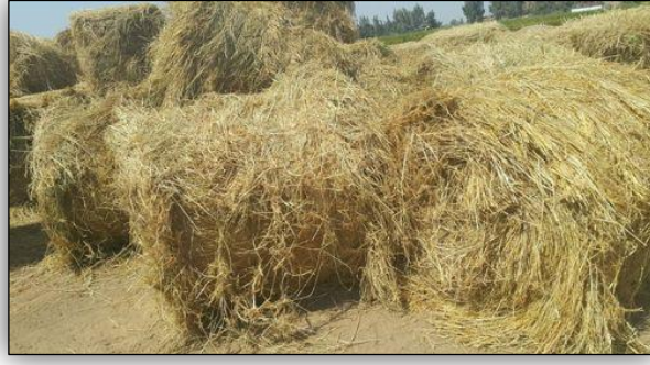
Resim 3.3: Kerpiç harcında kullanılan prinç samanı. (Rasha ELBORGY)
