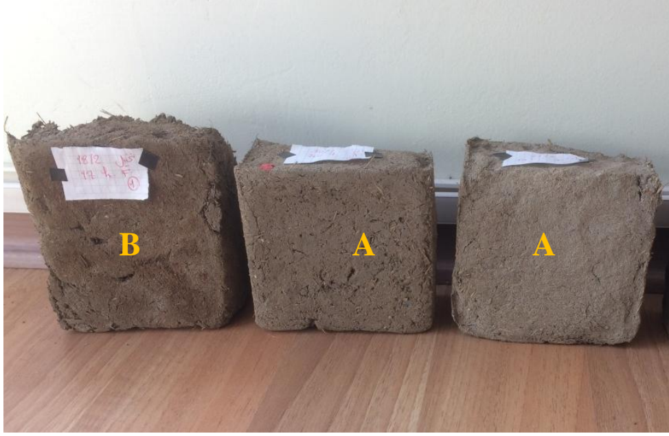
Resim 6.16: İki farklı samandan kerpiç yapılmış numunelerin karşılaştırılması (Hurma yaprağı, Pirinç samanı). B. Hurma yaprağından numune, A. Pirinç samanından numune. (Rasha ELBORG Y)
